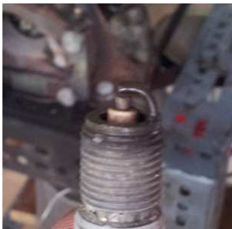
Figura 6. Bujía color café indicando una correcta combustión.
