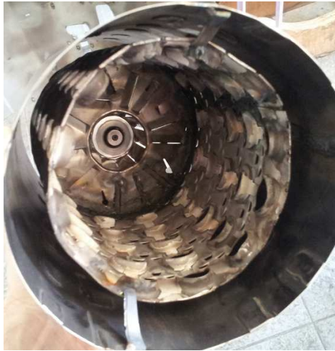
Figura 3. Detalle zonas cámara de combustión.
