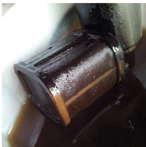
Figura 7. Filtro de baja presión de la toma de bomba de combustible con restos de aceite.
