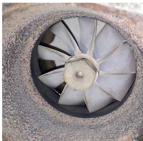
Figura 5. Detalle turbina sin residuos carbonosos.
