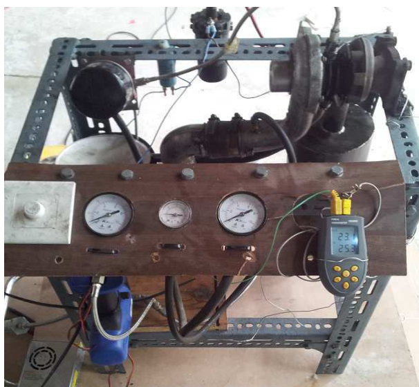
Figura 2. Motor a reacción a escala para ensayos.
