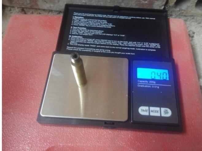
Figura 3.46. Llenado de la cápsula explosiva con bio - ANFO
