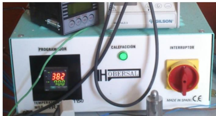
**Figura 3.3.** Controlador PID de temperatura del horno
