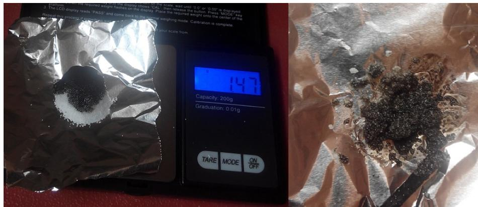
**Figura 3.43.** Proceso de mezclado de nitrato amónico con bioaceite para producir bio - ANFO
