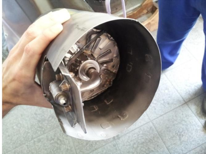
Figura 3.22. Detalle del alojamiento del inyector en la cámara de combustión durante su fabricación
