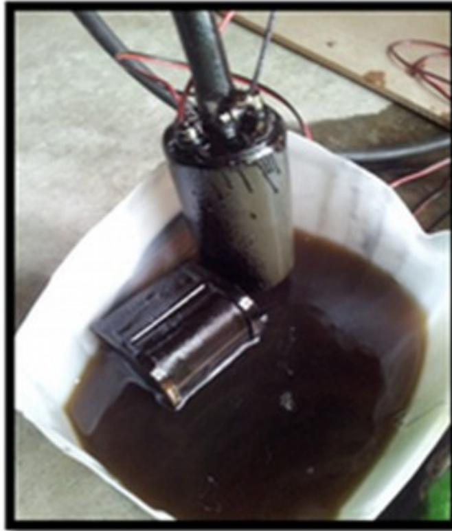
**Figura 3.27.** Detalle bomba y filtro de aspiración del sistema de alimentación de combustible
