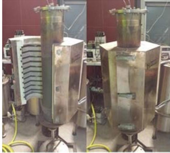
**Figura 3.2.** Horno abierto (izda) y cerrado (dcha)
