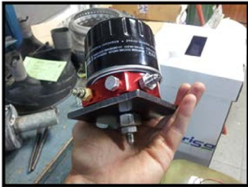
Figura 3.29. Conjunto filtro de aceite y sonda de presión
