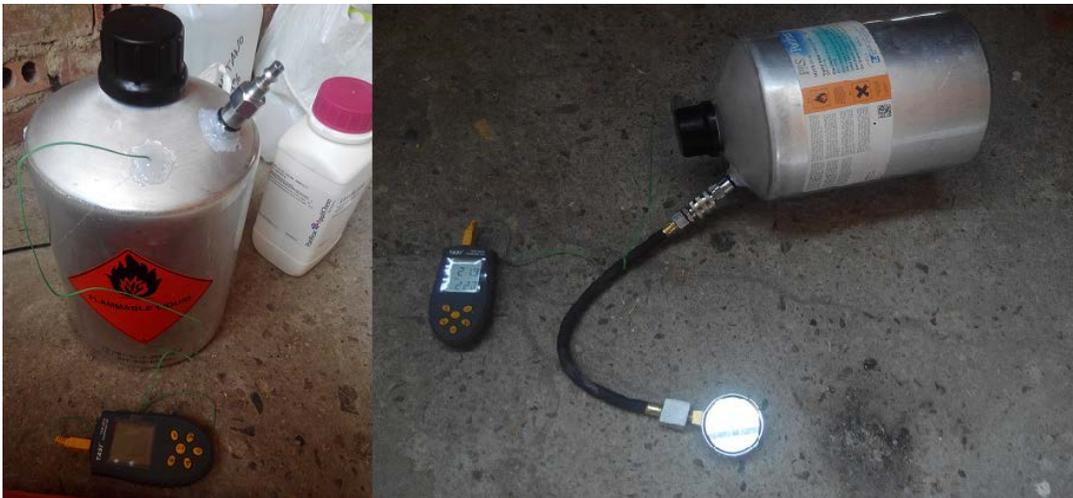
**Figura 3.48. Dispositivo para la toma de datos de las explosiones**
