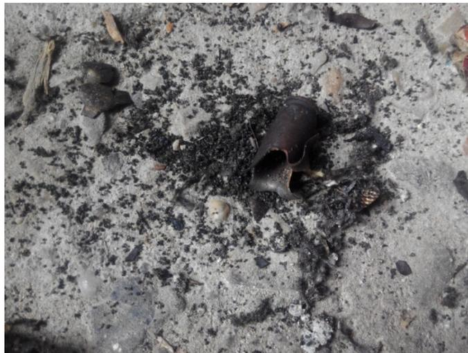
Figura 3.44. Restos no detonados de bio - ANFO
