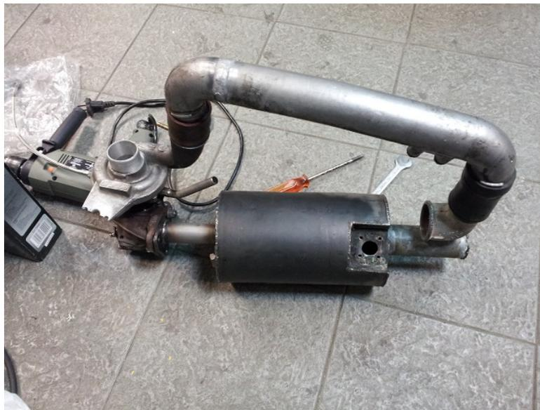
Figura 3.23. Situación de la cámara de combustión del motor experimental
