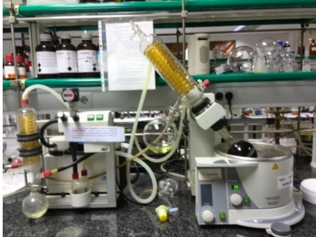
Figura 3.9. Eliminación en rotavapor de los disolventes orgánicos empleados en la extracción del bioaceite
