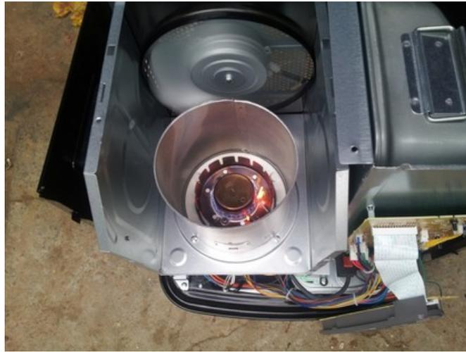
**Figura 3.42.** Funcionamiento de la estufa con queroseno y bioaceite
