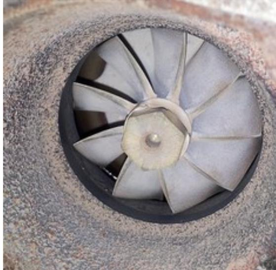
Figura 4.10. Detalle turbina sin residuos carbonosos
