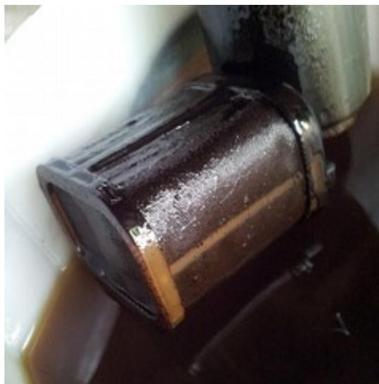
Figura 4.12. Filtro de baja presión de la toma de bomba de combustible con restos de aceite
