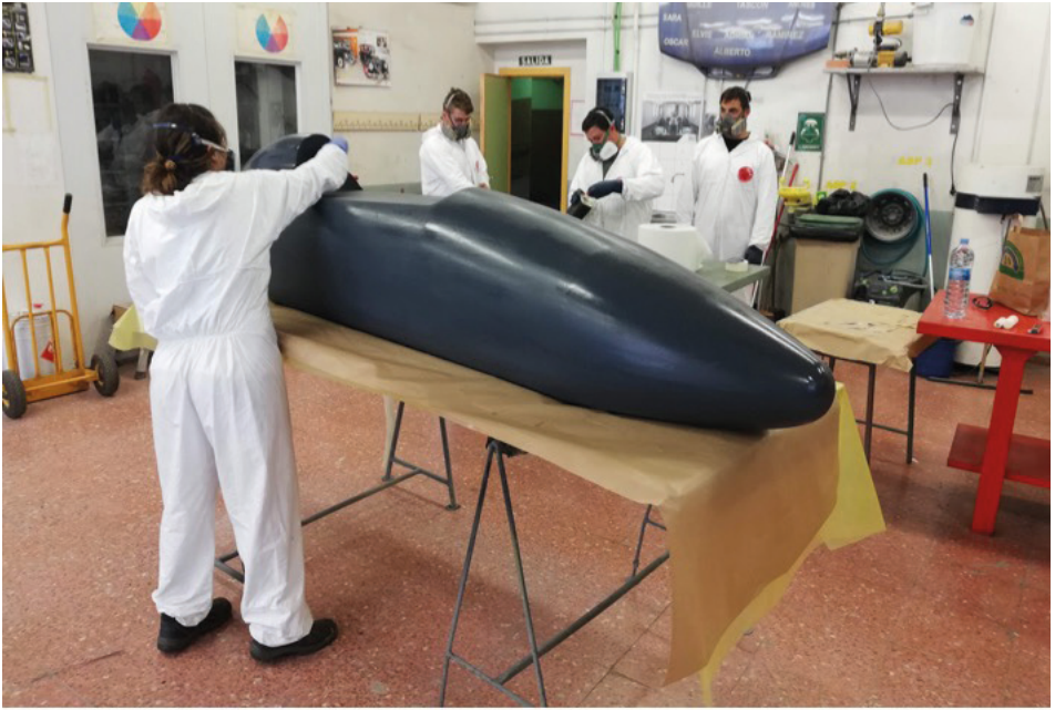
julio de 2019. Fabricación de moldes del coche RTULE-Inercia2
