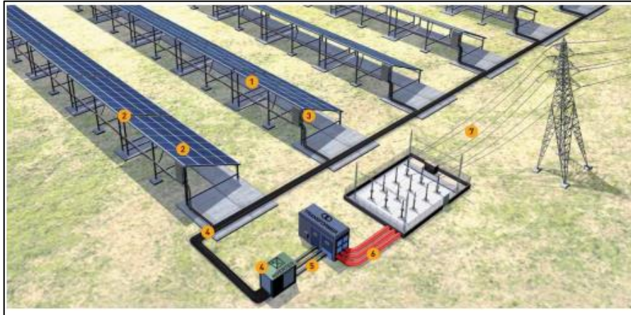
Figura 5.8: Instalación solar fotovoltaica tipo. Fuente [47]
