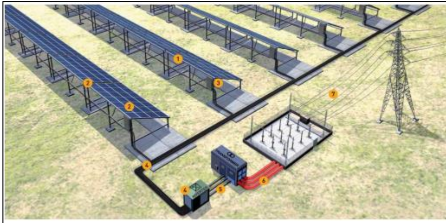
Figura 6.8: Instalación solar fotovoltaica tipo. Fuente [47]
