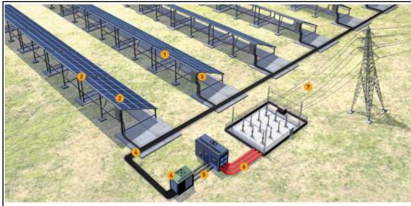
Figura 4.5: Instalación solar fotovoltaica tipo. Fuente [47]
