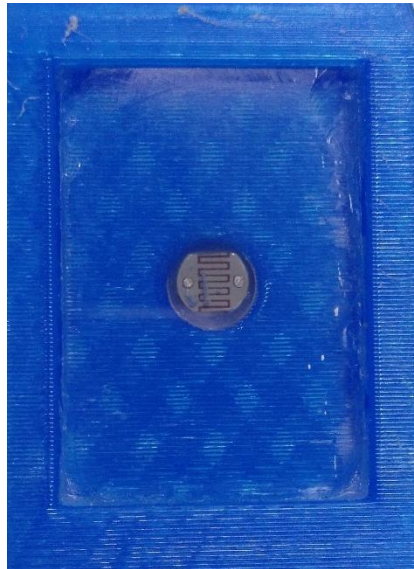
Figura 35 - Placa de vidrio cubriendo la resistencia LDR
