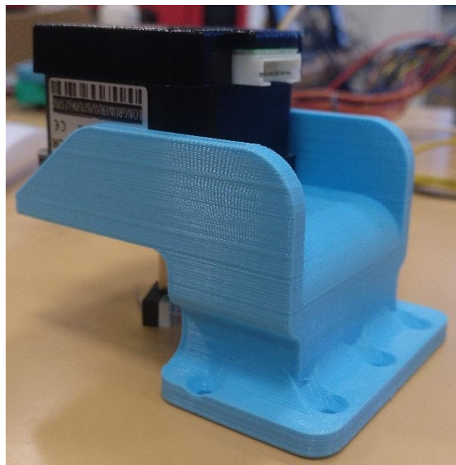
Figura 72 - Nueva piza diseñada para sujetar el motor de pasos
