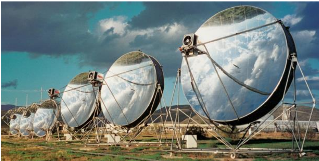
Figura 16 – Concentradores solares parabólicos circulares [14]
