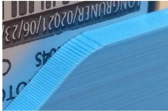
Figura 75 - Vista de las capas en una pieza curvada
