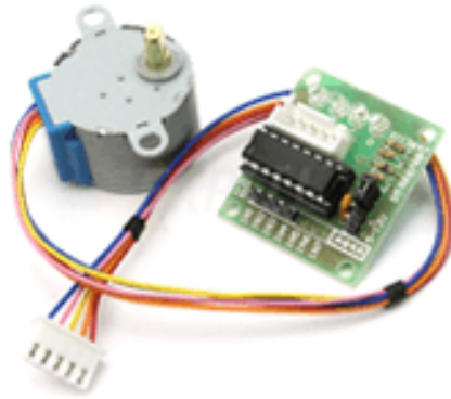
Figura 69 - Motor de pasos 28BYJ-48 y controlador ULN2003 [19]
