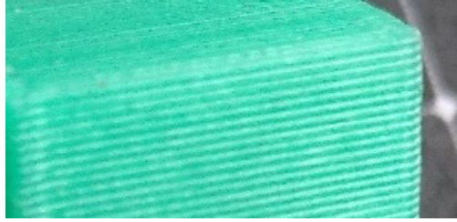
Figura 74 - Vista de las capas en una pieza de pendiente constante
