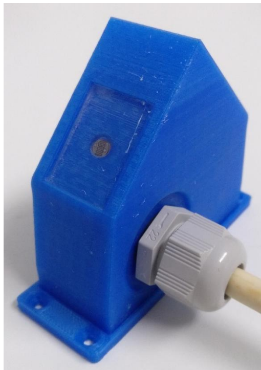
Figura 41 - Sensor de luz completamente montado
