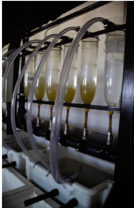
Fotografía 4. Batería de botellas tipo Zug para la incubación de huevos de tenca, piscifactoría Casaseca de las Chanas, Zamora. (Fuente: Departamento de Producción Animal).
