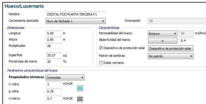
Figura 6.37.- Cristal fijo planta tercera sobre la fachada 1.
