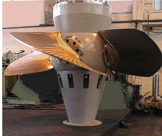
Figura 2.2.3.1.- Turbina Kaplan.
