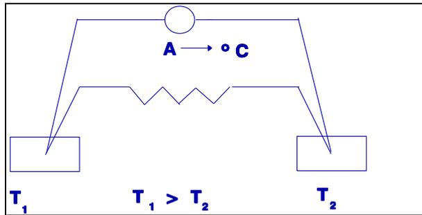
Efecto SEEBECK que consiste en que entre una soldadura de dos metales a una temperatura " $T_1$ " y otra a " $T_2$ " se establece una diferencia de potencial.
