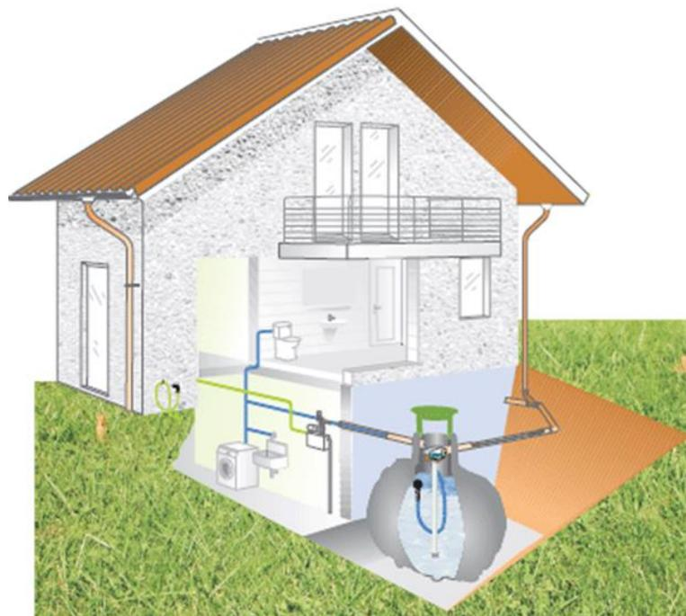
Figura 5.13.- Esquema de instalación de recogida de aguas pluviales.
