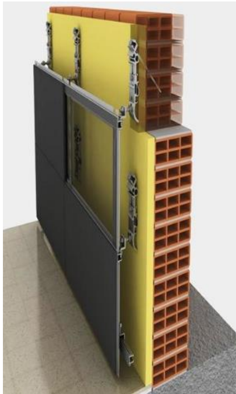
Ilustración 6-2 Aislamiento exterior con fachada ventilada
