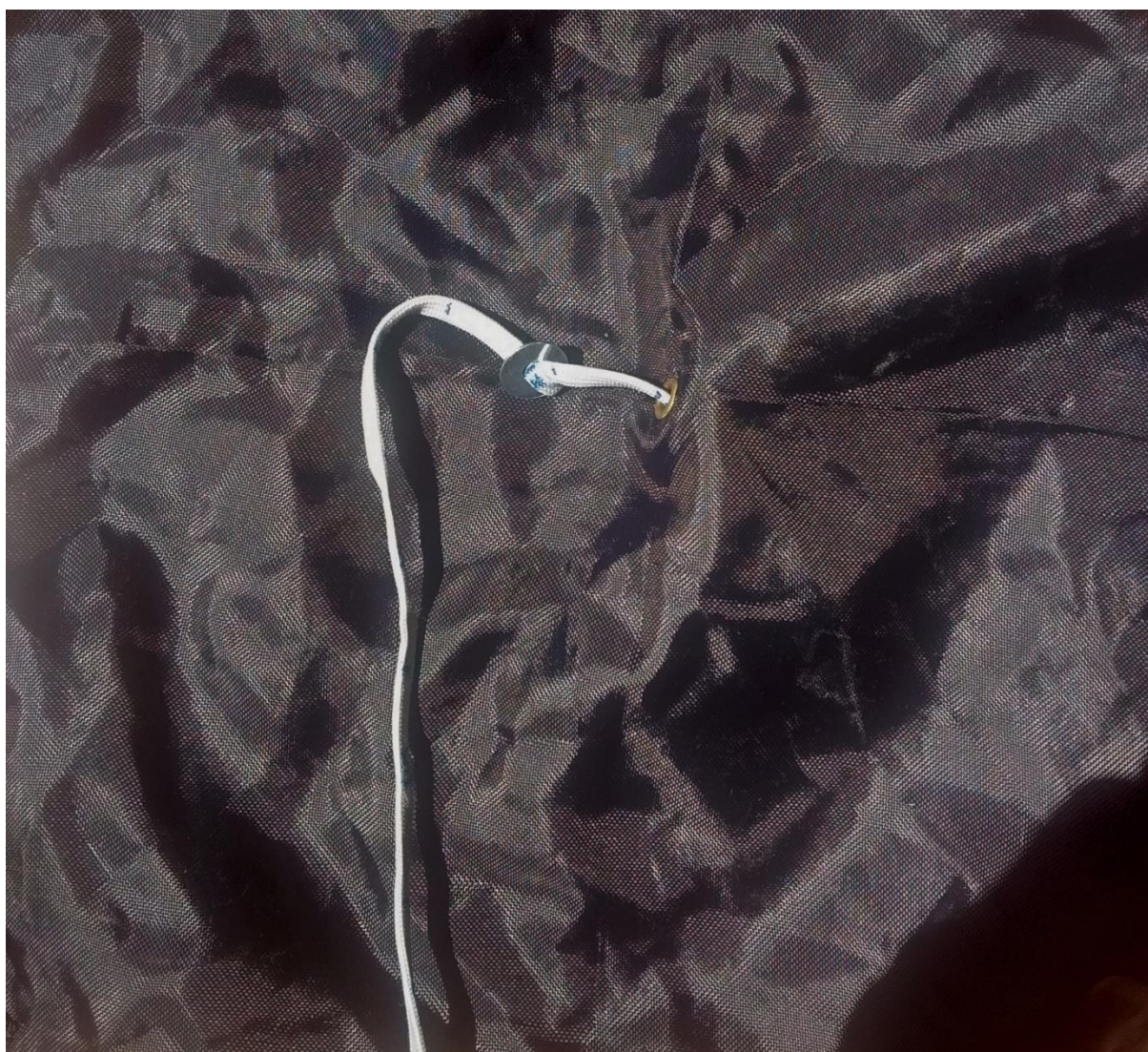
Figura 11. Arandela de ajuste de la carga, con medidas cada 2,5 centímetros en el cordón de reglaje.
