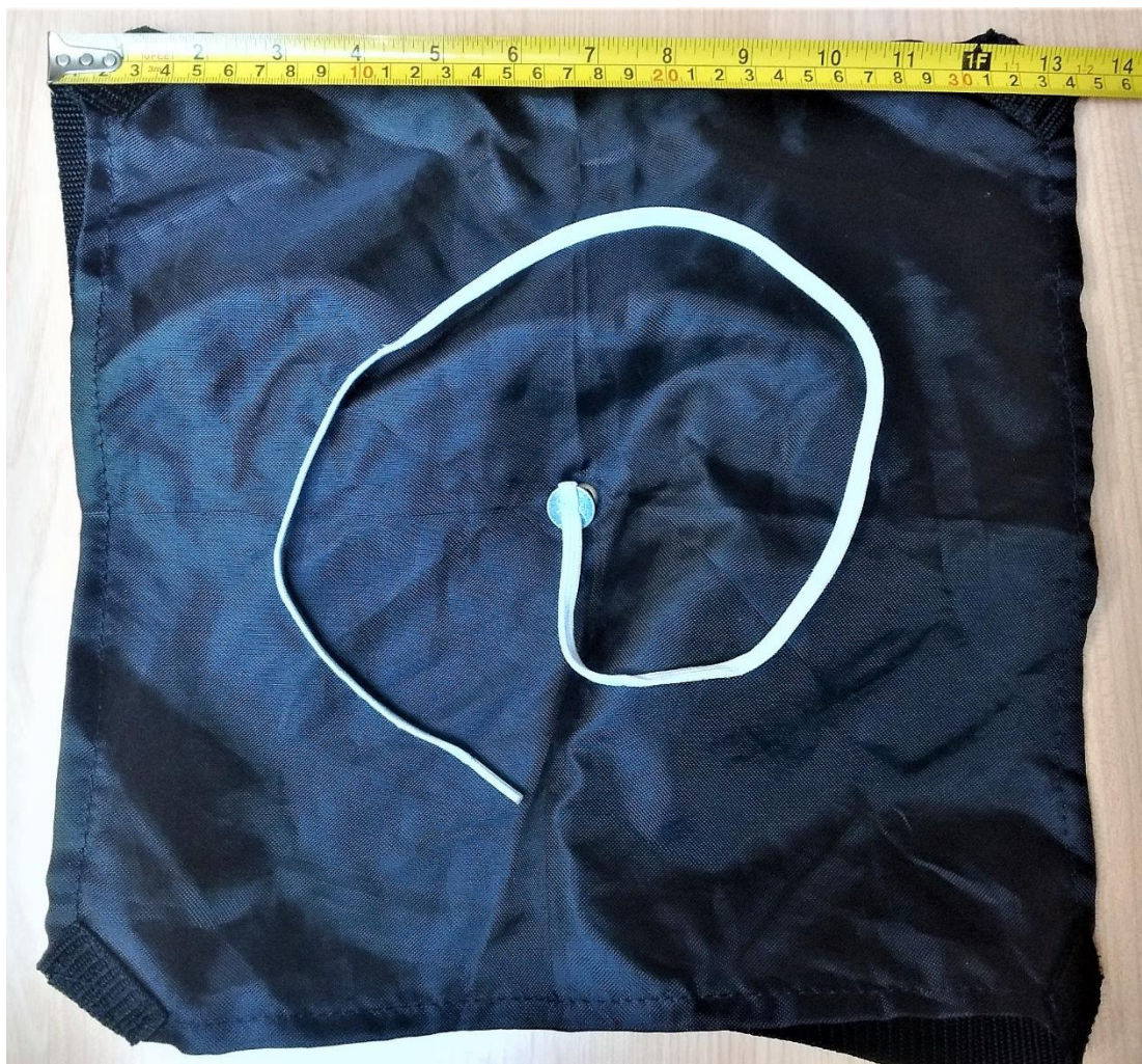
Figura 9. Superficie del paracaídas (34x34 centímetros), cordón y arandela de reglaje.
