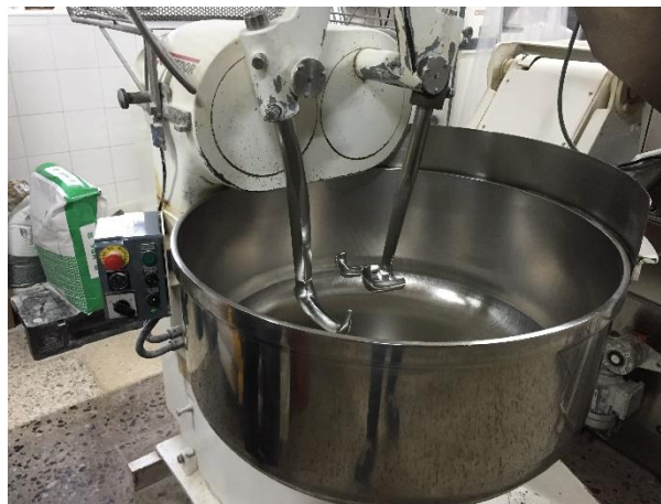
Imagen 10. Amasadora con el resguardo retirado. Elaboración propia.
