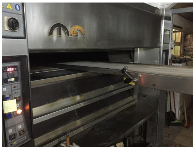
Imagen 8. Cargador puente múltiple entrando al horno. Elaboración propia.
