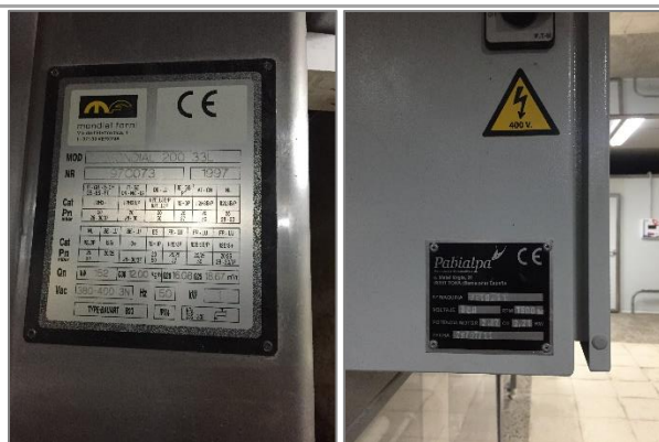
Imágenes 25 y 26. Ejemplos del marcado CE del horno y tren de laboreo. Elaboración propia.
