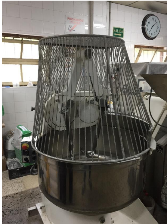
Imagen 11. Amasadora con el resguardo bajado. Elaboración propia.
