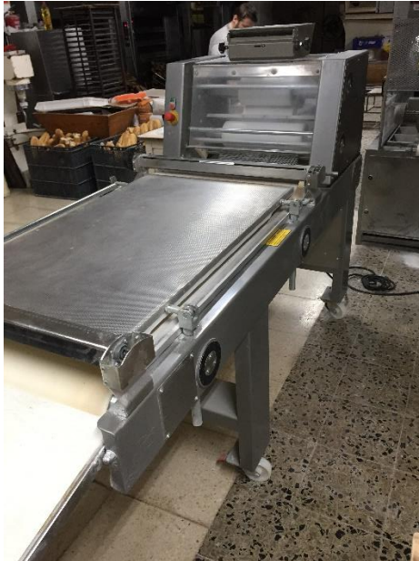
Imagen 15. Formadora de barras con cinta de salida. Elaboración propia.
