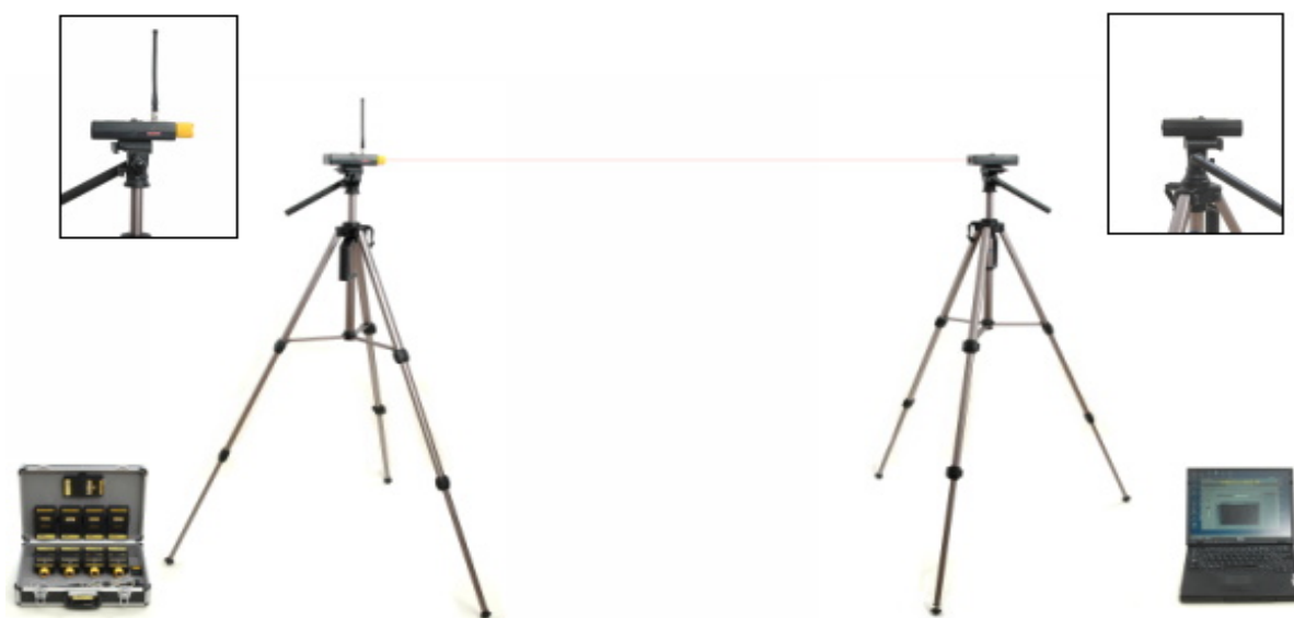
Figura 10. Células fotoeléctricas utilizadas en el test de Bangsbo y en el test RSA.
