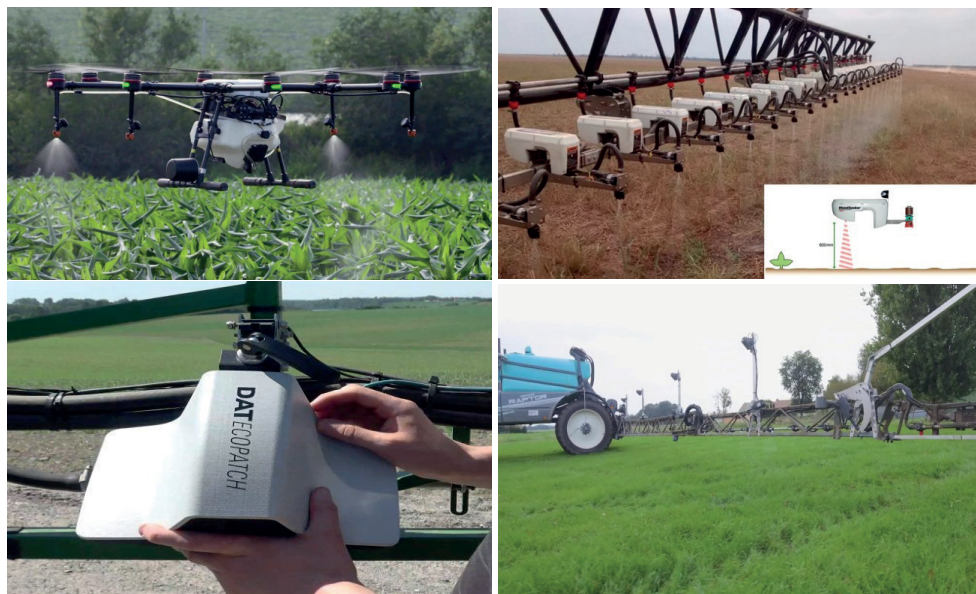
Figura 15.-. Dron multirotor con dispositivo aplicador. Sistema weedseeker de Trimble para la detección de biomasa con infrarrojos y decidir si abre o no la boquilla correspondiente. Cámara-sensor DAT Ecopatch mediante imagen RGB. Sistema Berthoud Impact con cámaras multispectrales cada 1,5 m.
