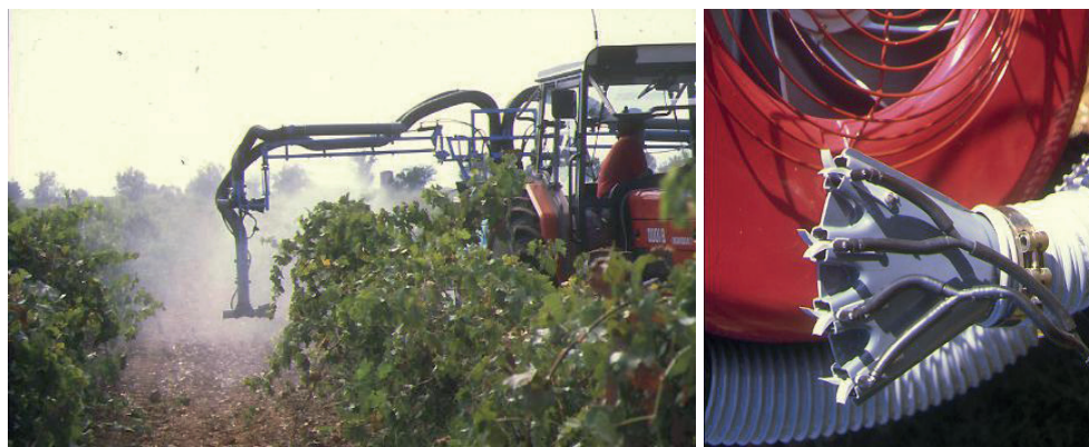
Figura 7.- Equipo de aplicación neumático. Detalle de una tobera
