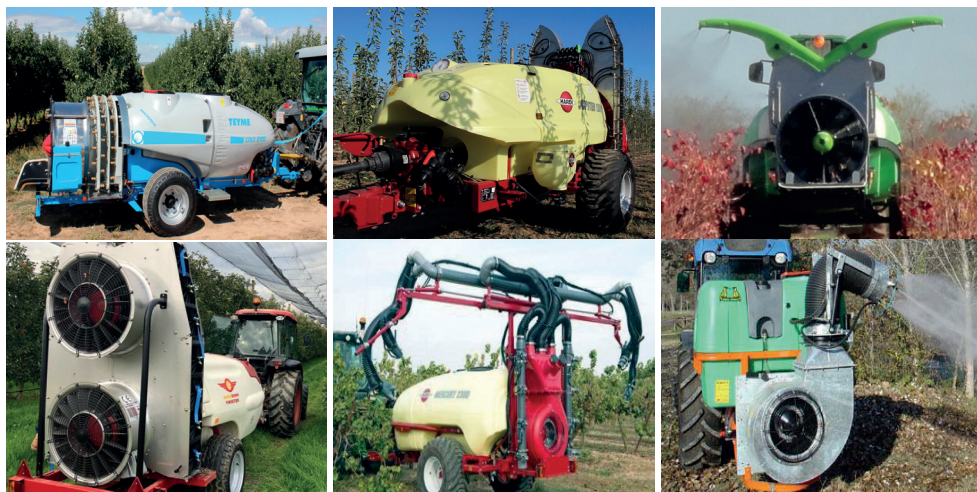
Figura 6.- Equipo hidroneumático convencional con triple arco portaboquillas. Con pantallas o deflectores verticales. Con deflectores horizontales. Con dos ventiladores. Con colectores tipo cañón.
