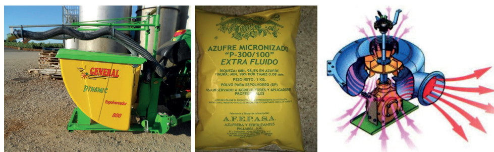
Figura 10.- Equipo espolvoreador. Saco de azufre en polvo. Detalle del ventilador centrífugo
