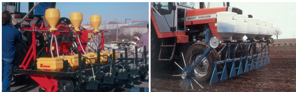
Figura 11.- Equipo de siembra con aplicación de microgránulos en profundidad. En superficie
