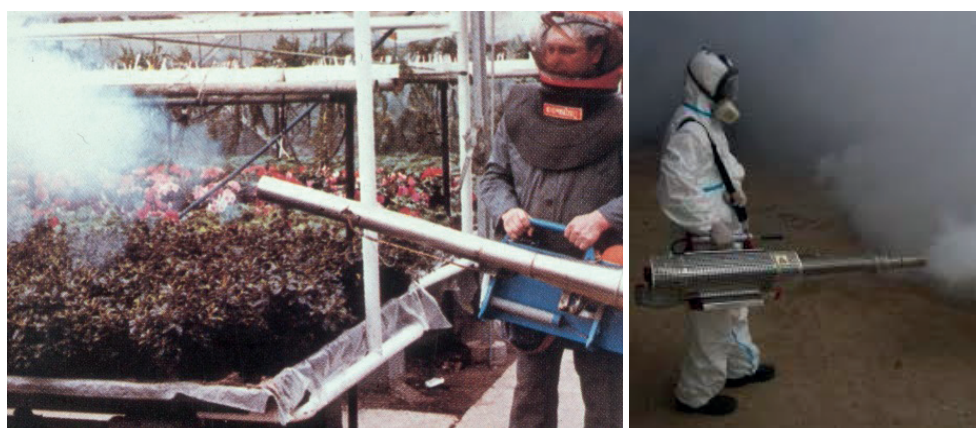
Figura 9.- Equipos de aplicación termoneumáticos tratando en recintos cerrados.
