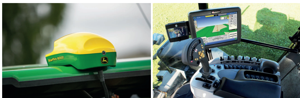
Figura 14.-. Detalle antena receptora sistema de posicionamiento por GPS. Detalle del sistema de autoguiado en el interior de la cabina.
