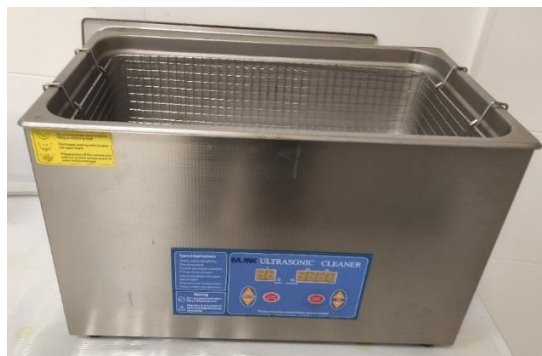
Figura 3-8 Máquina ultrasonidos 820HTD
