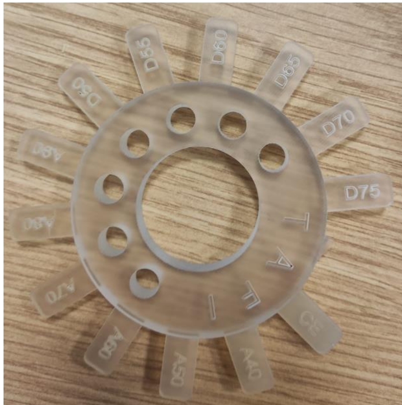
Figura 2-2 Rueda con dientes de las distintas durezas que puede otorgar la máquina MJP 5600 a las piezas
