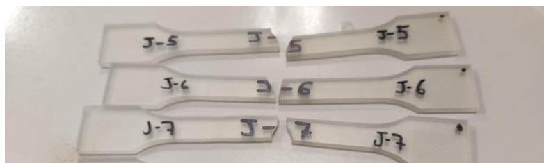
Figura 4-8 Probetas nuevas con post procesado de aceite Jonhson
