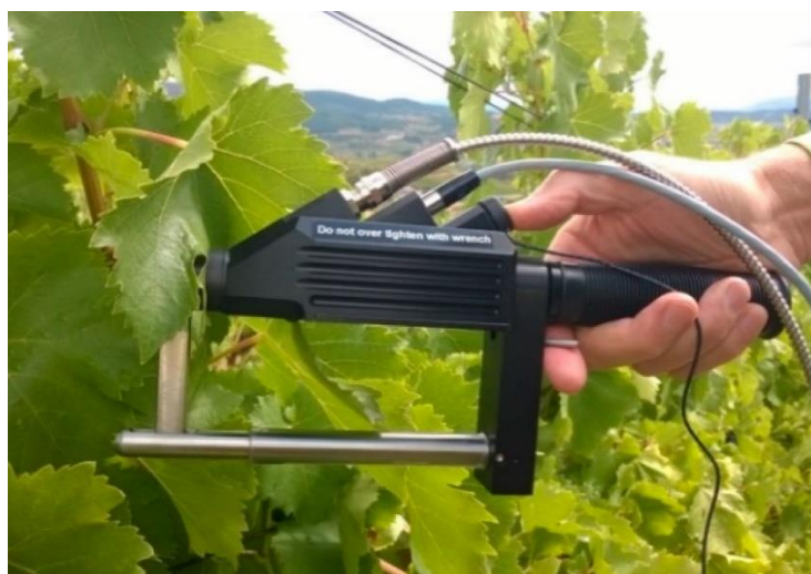
Figura 3. Recopilación de datos espectrales utilizando una sonda de planta y accesorios de clip de hoja.
