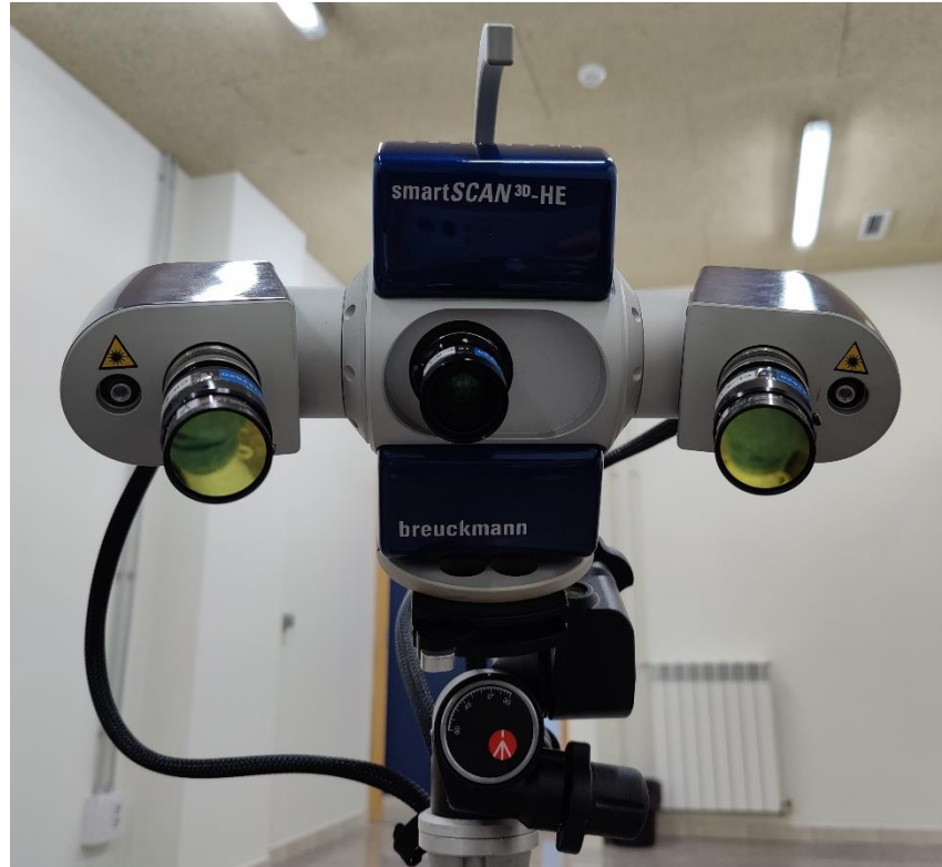
Figura 4.20. Fotografía de las 2 cámaras, situadas en los laterales, y del proyector, situado en el centro, del escáner Breuckmann SmartScan, disponible en la unidad UFI3D de la Universidad de León.
