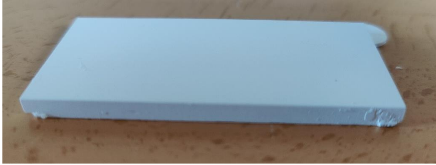
Figura 6.41. Fotografía de la pieza 3 después del proceso de debinding en la que se pueden apreciar las marcas que dejan los soportes tras su retirada.
