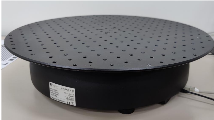
Figura 4.21. Fotografía de la mesa rotatoria sobre la que se colocan las piezas para ser escaneadas
