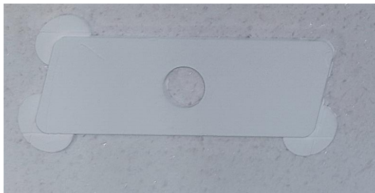
Figura 6.28. Fotografía de la base de la pieza 2 con los soportes después de haber salido del proceso de limpieza tras la impresión.
