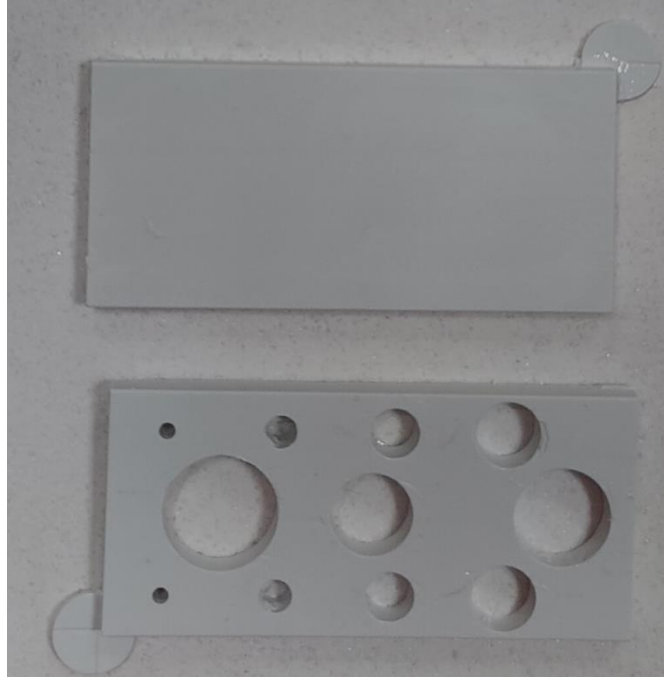
Figura 6.40. Fotografía de las piezas 3 y 4 después de haber salido del proceso de limpieza tras finalizar la impresión.
