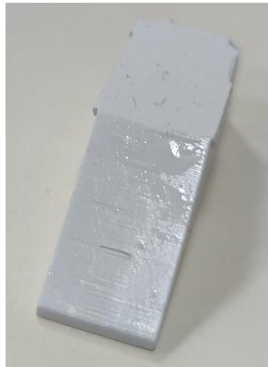
Figura 6.101. Fotografía de la pieza 8 fabricada con el segundo tipo de soporte en la que se pueden apreciar los defectos producidos en el centro de la superficie del voladizo, que corresponde con la zona en la que no existía soporte.
