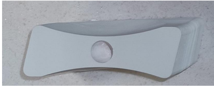
Figura 6.29. Fotografía de la otra parte de la pieza 2 después de haber salido del proceso de limpieza tras la impresión. En esta imagen se puede apreciar en la parte derecha de la pieza el desplazamiento de las capas.
