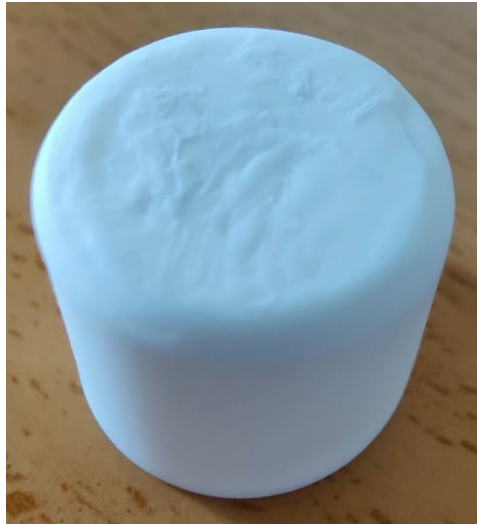
Figura 6.62. Fotografía de la pieza 5 tras el proceso de sinterizado en la que se puede apreciar la mala calidad superficial de la base de la pieza.
