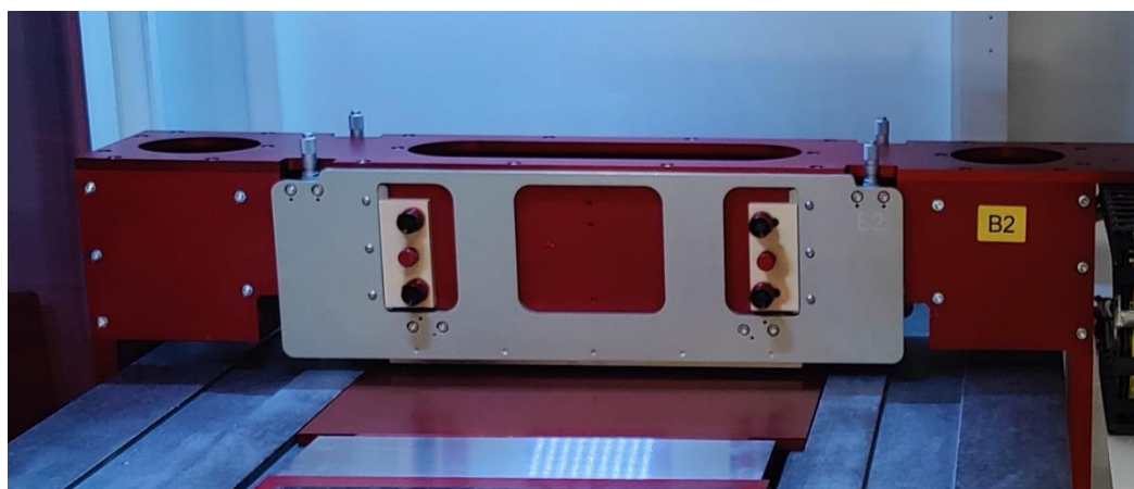
Figura 4.6. Fotografía del scraper en la que se puede apreciar una de sus 2 cuchillas, pudiendo ver en la parte superior de la misma los tornillos micrométricos empleados para su ajuste.
