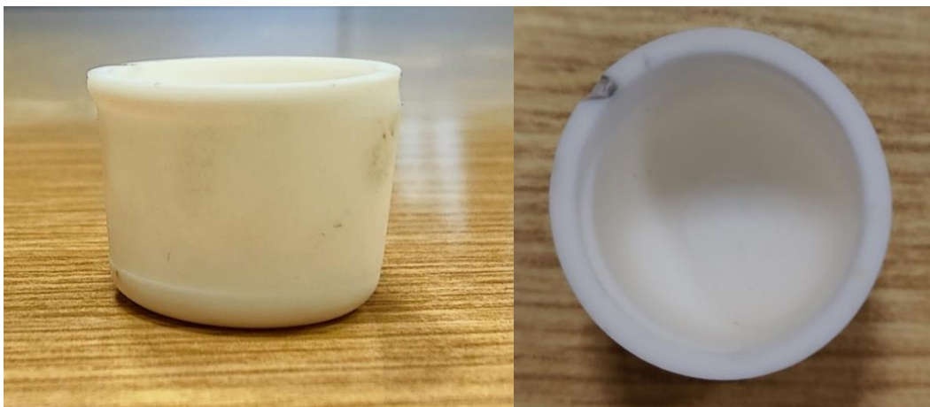
Figura 6.49. Fotografías de la pieza 5 impresa sin soportes tras haber finalizado todo el proceso de fabricación.
