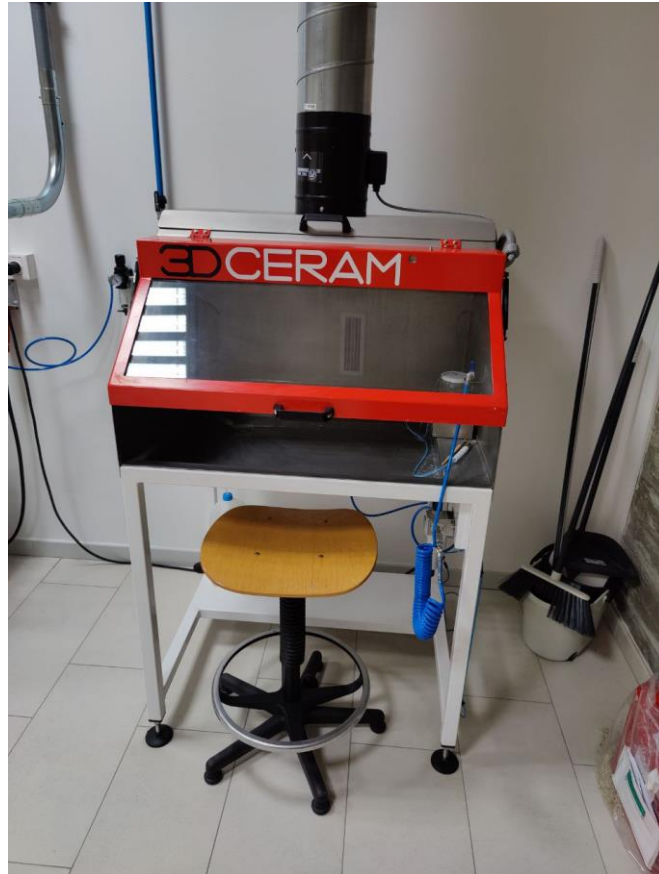
Figura 4.11. Fotografía de la estación de limpieza para las piezas disponible en la unidad UFI3D de la Universidad de León.
