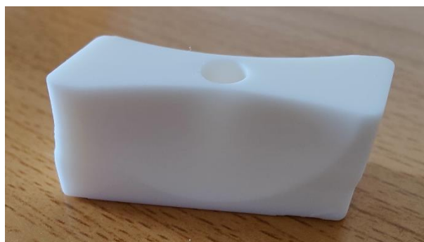
Figura 6.33. Fotografía de la otra parte de la pieza 2 impresa con soportes tras haber finalizado el proceso de sinterizado.
