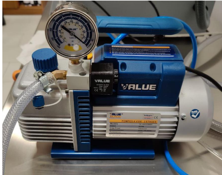
Figura 4.15. Fotografía de la bomba disponible en la unidad UFI3D de la Universidad de León, empleada para la extracción del aire del interior del horno durante el proceso de debinding.
