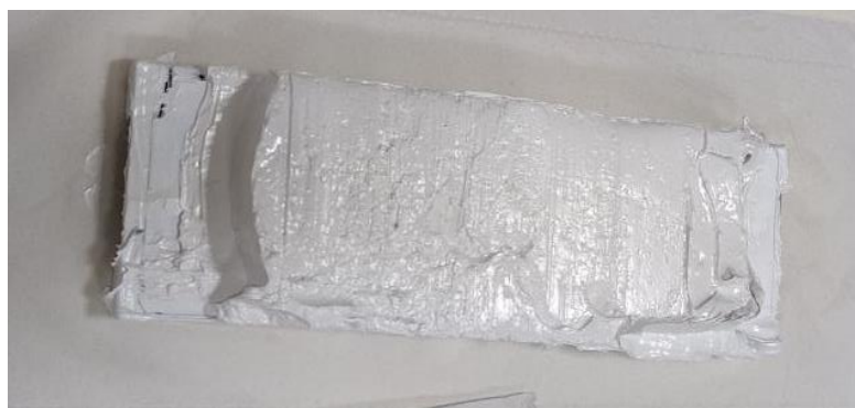
Figura 4.10. Fotografía de la cama de impresión extraída de la máquina tras el proceso de impresión y tras haber retirado pasta de las esquinas para permitir su extracción.
