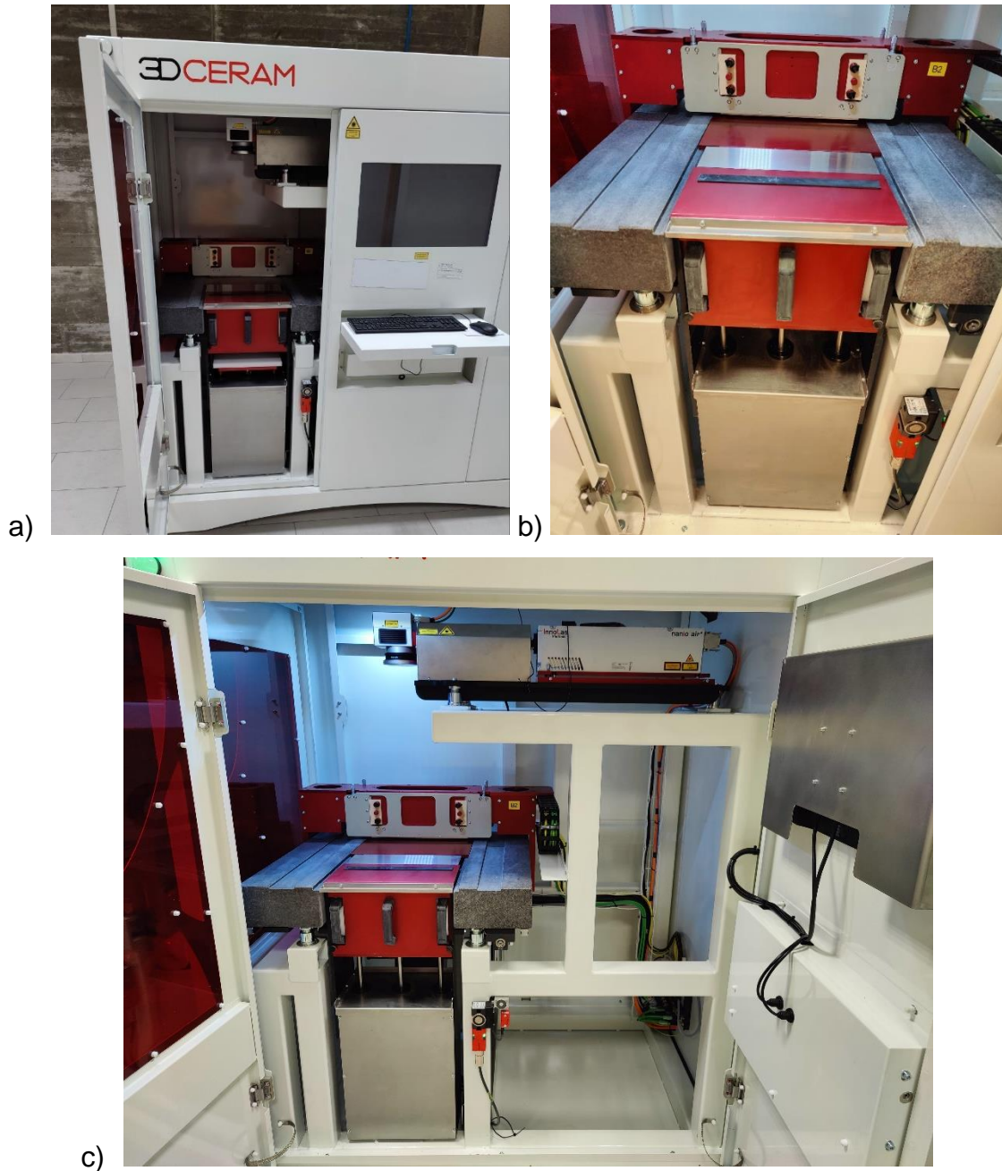
Figura 4.1. a) Fotografía de la máquina de estereolitografía 3DCERAM C900 FLEX disponible en la unidad UFI3D de la Universidad de León; b) Fotografía de la zona de impresión de la máquina de estereolitografía 3DCERAM C900 FLEX disponible en la unidad UFI3D de la Universidad de León; c) Fotografía del interior la de la máquina de estereolitografía 3DCERAM C900 FLEX disponible en la unidad UFI3D de la Universidad de León en la que se puede apreciar el láser en la parte superior de la misma.
