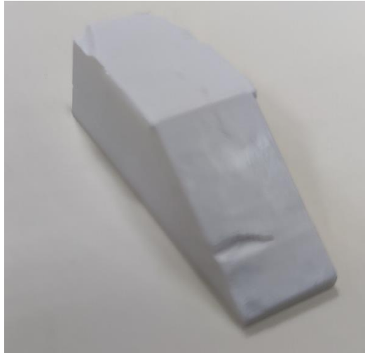
Figura 6.102. Fotografía de la pieza 8 fabricada con el tercer tipo de soporte empleado para su fabricación en la que se puede apreciar la muesca producida en la parte inferior izquierda de la superficie del voladizo.
