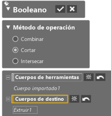
Figura 6.53. Imagen del cuadro de diálogo de la opción de operaciones booleanas en el software Geomagic Design X.
