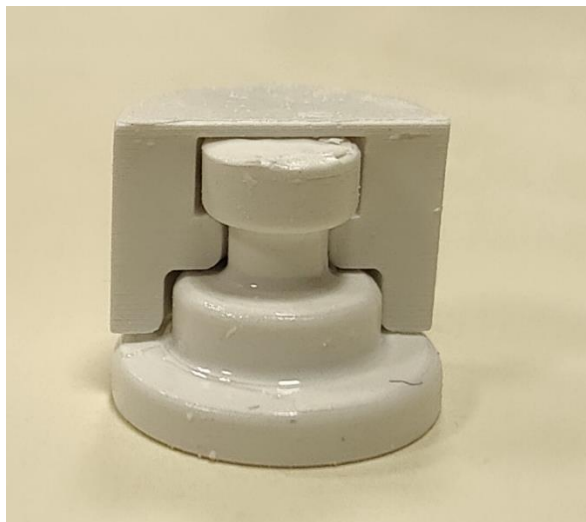
Figura 6.93. a) Fotografía de la pieza 7 tras su limpieza después de haber finalizado el proceso de impresión; b) Fotografía del soporte empleado para la pieza 7 tras su limpieza después de haber finalizado el proceso de impresión; c) Fotografía de la pieza 7 con una de las partes que conforman el soporte empleado para su fabricación en la que se puede apreciar el espacio existente entre ambas partes.
