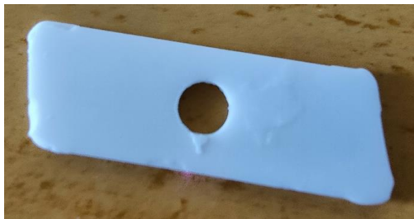
Figura 6.32. Fotografía de la base de la pieza 2 impresa con soportes tras haber finalizado el proceso de sinterizado.
