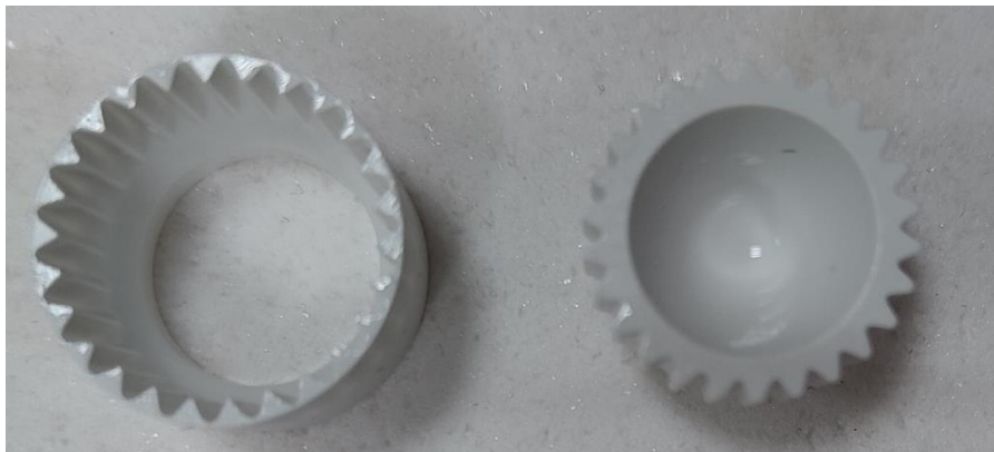
Figura 6.76. Fotografía de la pieza 6 y de su soporte después de haber finalizado las labores de limpieza de ambos tras su impresión.
