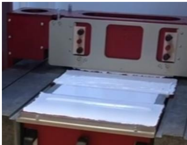
Figura 4.9. Imagen de la pasta distribuida sobre la zona de impresión .
