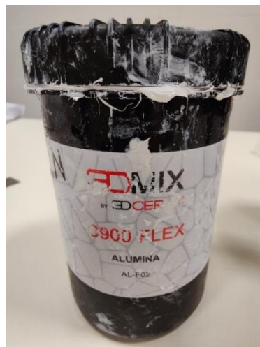
Figura 5.1. Fotografía de uno de los botes de pasta de alúmina empleados para la fabricación de las piezas de alúmina mediante SLA en la unidad UFI3D.
