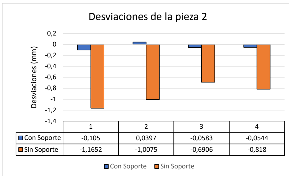
Figura 6.36. Gráfico comparativo de las desviaciones producidas por el efecto curling en la pieza fabricada sin soportes, con las producidas en la pieza fabricada con soportes.
