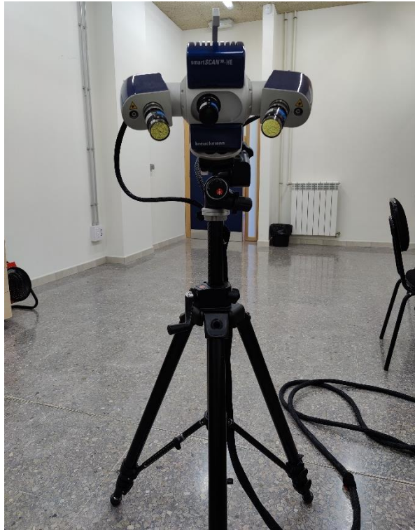
Figura 4.19. Fotografía del escáner Breuckmann SmartScan empleado para el escaneado de las piezas impresas, disponible en la unidad UFI3D de la Universidad de León.
