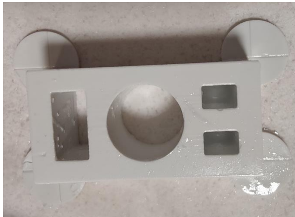
Figura 6.14. Fotografía de la pieza 1 tras el proceso de impresión y de limpieza de la misma en la que se pueden apreciar tanto los soportes como las marcas realizadas en los mismos para su posterior eliminación.
