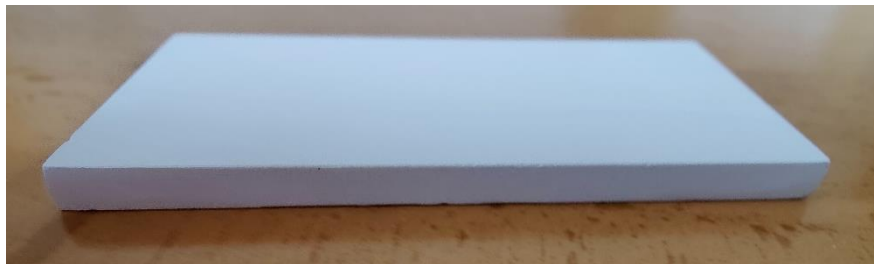
Figura 6.42. Fotografía de la pieza 3 después del lijado de las marcas que dejan los soportes tras su eliminación.
