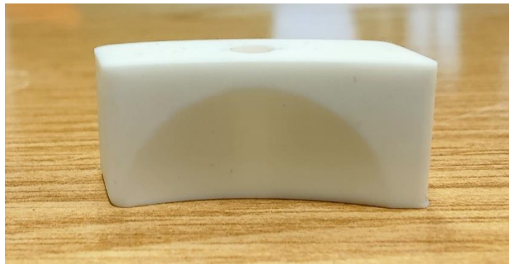
Figura 6.21. Fotografía de la pieza 2 impresa sin soportes tras haber finalizado el proceso de fabricación en la que se puede apreciar su base.
