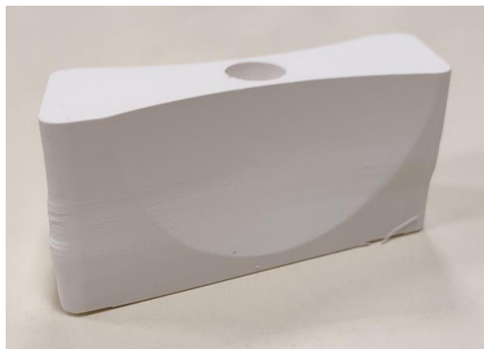
Figura 6.31. Fotografía de la otra parte de la pieza 2 tras salir del horno de debinding.
