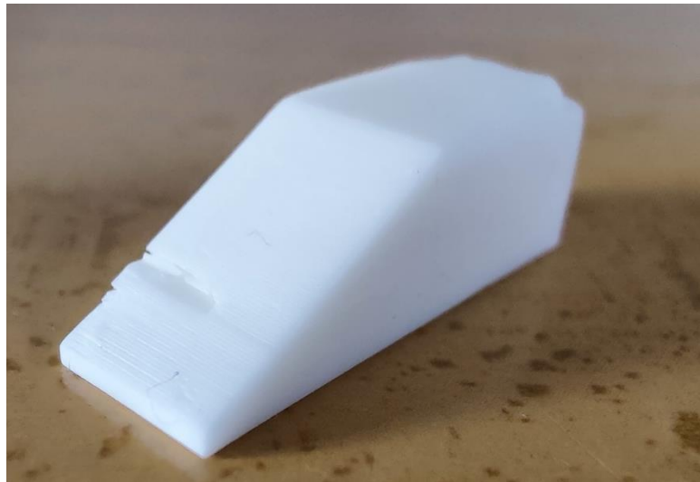
Figura 6.104. a) Fotografía de la pieza 8 impresa con el segundo tipo de soporte tras haber salido del horno de sinterizado; b) Fotografía de la pieza 8 impresa con el tercer tipo de soporte tras haber salido del horno de sinterizado.
