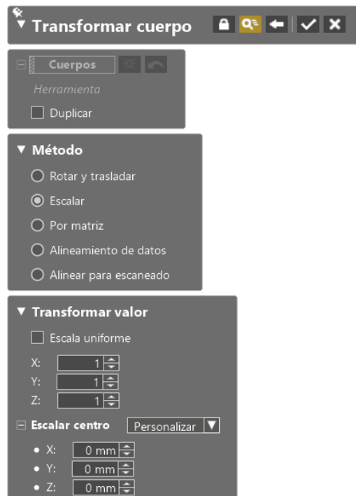
Figura 6.51. Imagen del cuadro de diálogo de la opción “Transformar cuerpo” para realizar el escalado de la copia de la pieza en el software Geomagic Design X.
