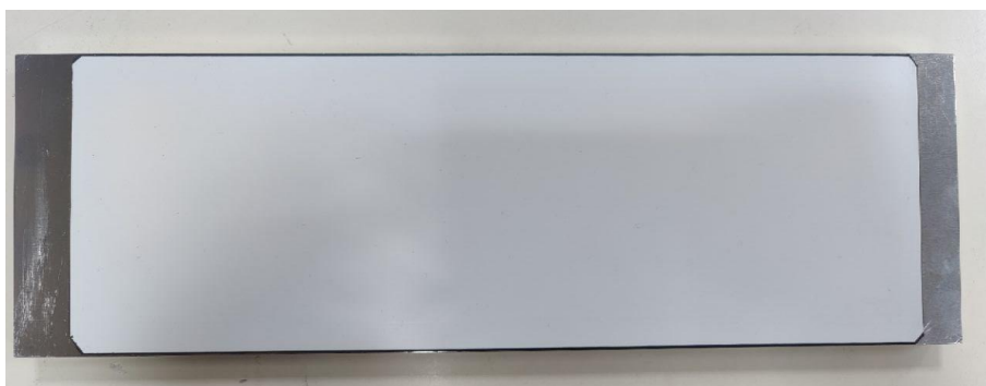
Figura 4.5. Fotografía de la cama de impresión ya preparada con la placa magnética blanca, lista para seguir con el proceso de preparación de la máquina para la impresión.
