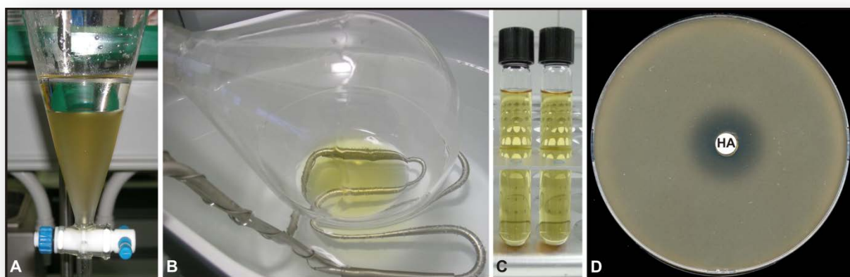
Figura 33. Proceso de extracción del HA para su posterior purificación. A) Tras la precipitación con acetona, el caldo fue extraído con acetato de etilo recuperándose la fase superior. B) Evaporación en el rotavapor de la muestra extraída. C) Muestra concentrada resuspendida en acetonitrilo. D) Bioensayo frente a la levadura K. marxianus del HA purificado disuelto en acetonitrilo (previamente se comprobó que este solvente no inhibía el crecimiento de la levadura).
