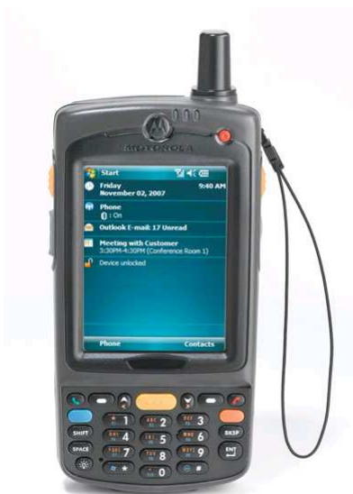
Figura 8.13: Terminal portátil de captura de datos MC75 de Motorola
