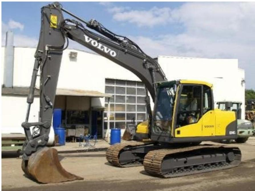
Ilustración 18: Excavadora volvo EC140 CL
