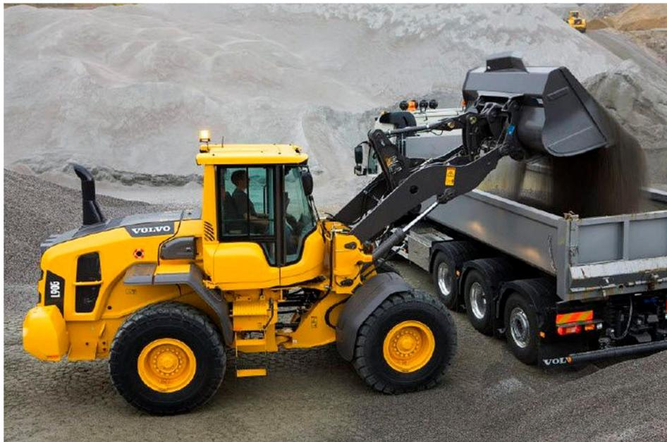
Ilustración 16: Pala cargadora Volvo L90G
