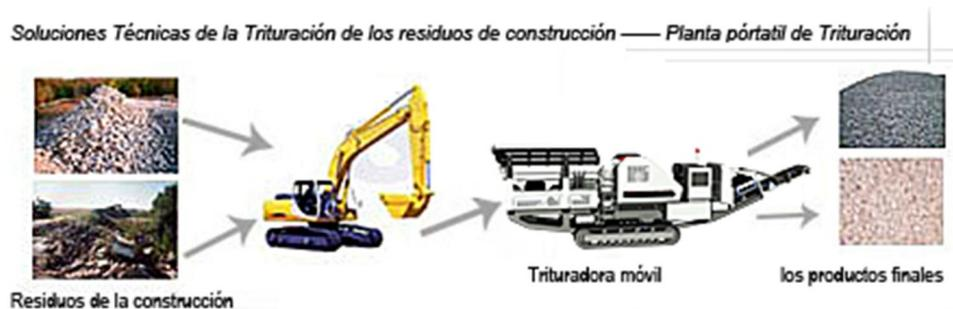
Ilustración 8: Ejemplo simplificado del proceso de reciclaje de áridos
