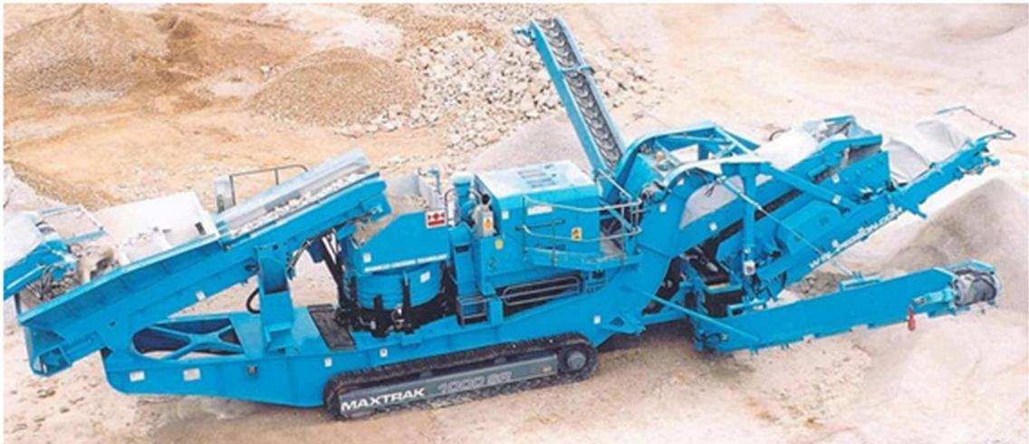
Ilustración 21: Molino Automax con criba en un mismo módulo
