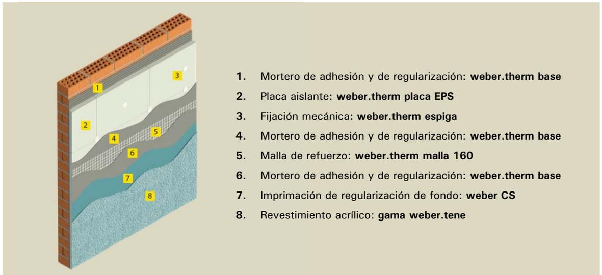
**Observación:** posibilidad de utilizar **weber.therm placa EPS** grafito en lugar de **weber.therm placa EPS** para dotar al sistema de una capacidad aislante mayor.
