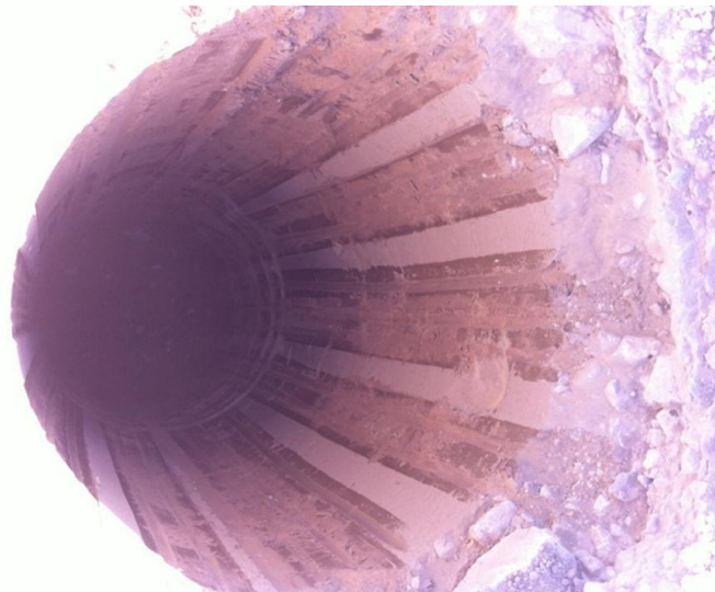
Figura 4.8 Primeros metros de un sondeo realizado con martillo en fondo
