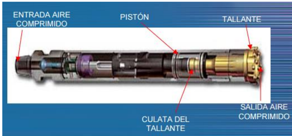
Figura 4.10 Esquema de un martillo en fondo
