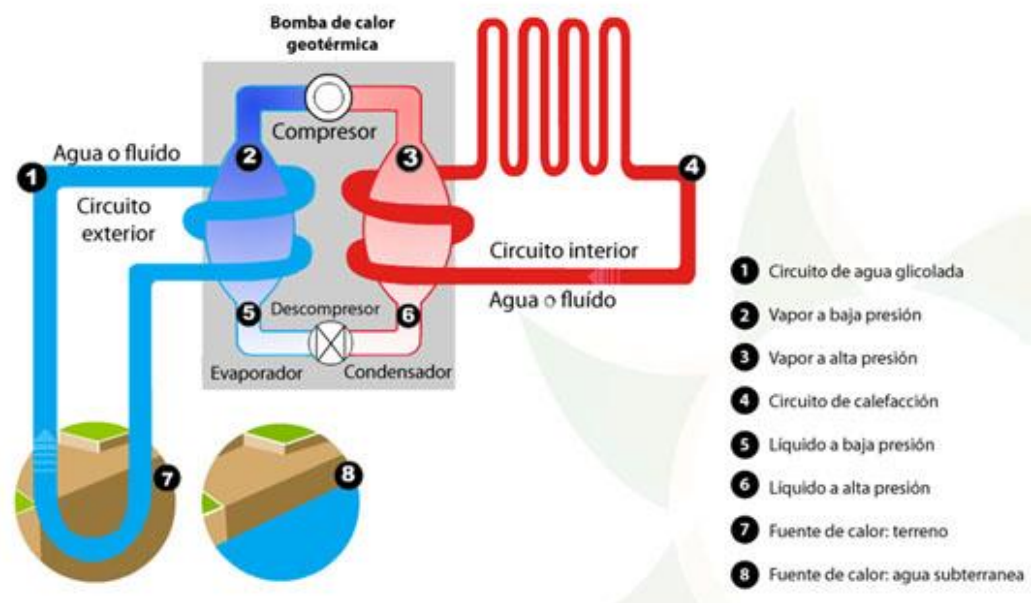
Figura 2.2 Esquema de funcionamiento de una bomba de calor geotérmica
