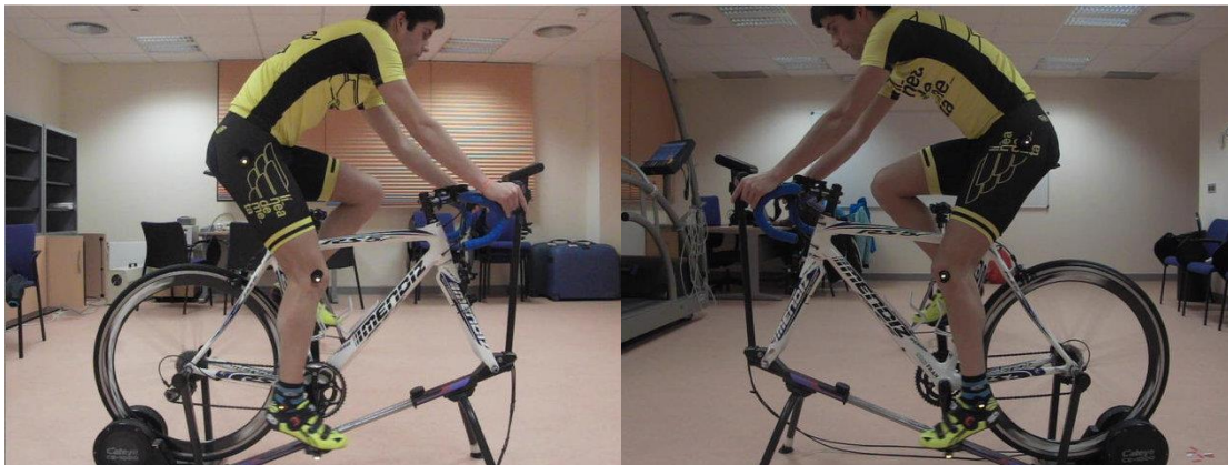
Figura 2. Diodos leds colocados en las diferentes articulaciones (rodilla, tobillo y cadera) y en el eje de rotación del pedal. Filmación del perfil derecho e izquierdo.
