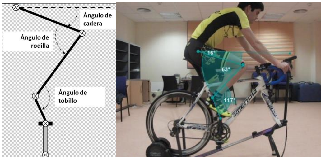
Figura 3. Convención utilizada para el análisis de los ángulos máximos (extensión) y mínimos (flexión) de cada articulación (izquierda). Ejemplo de ángulos tomados con el software Kinovea sobre la propia imagen del ciclista (derecha).
