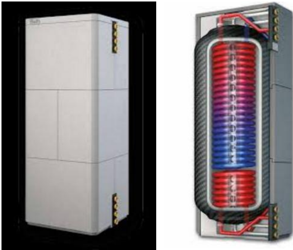
Figura 6.17.- Depósito de inercia y acumulación Roth Quadroline TQ-T500.
