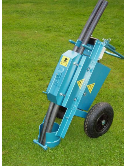
Figura 6.12.- Aparato introducción de sondas.
