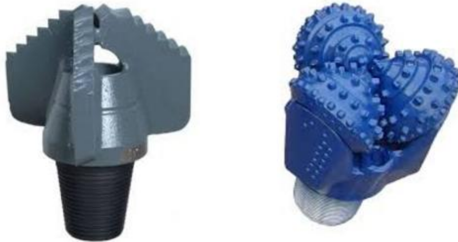
Figura 6.10. Cabezas de perforación.
