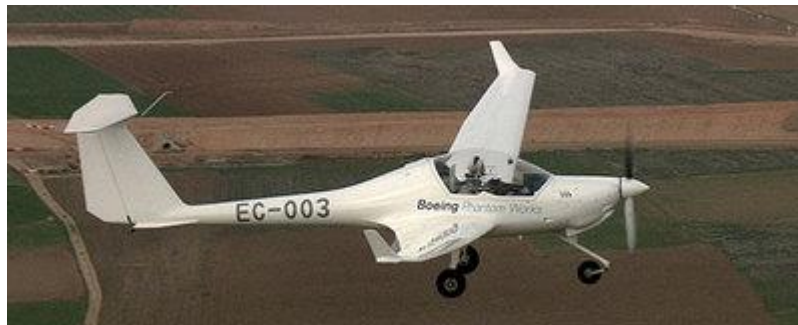
Figura 5.6: Primera avioneta propulsada por pila de hidrógeno
