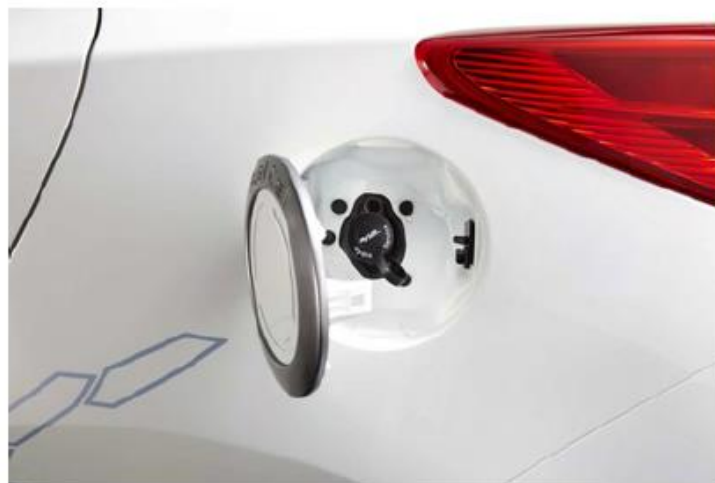
Figura 5.4: Toma de repostaje del Hyundai ix35 FCVE
