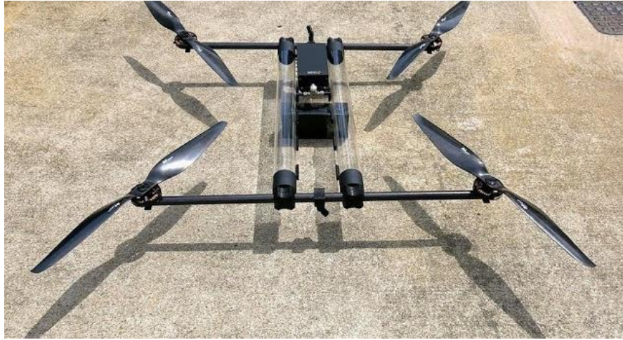
Figura 5.7: Dron Hycopter propulsado por pila de hidrógeno. Fuente: Tecnoneo
