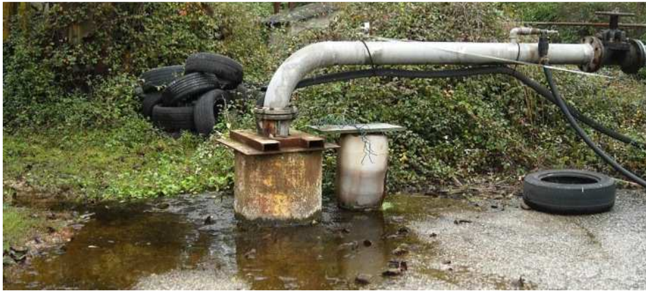
Imagen 40.- Sondeo en las inmediaciones del pozo de ventilación de Granda. Surgencia artesiana
