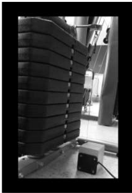
Figura 13. Colocación del encoder en la máquina de extensión de rodillas para tomar la medida de la potencia.
