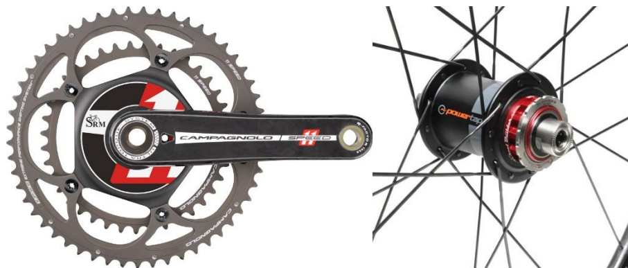
Figura 1.- Ilustración del medidor de potencia entre el plato y la biela (SRM, izquierda) y en el eje de la rueda trasera (Powertap, derecha).
