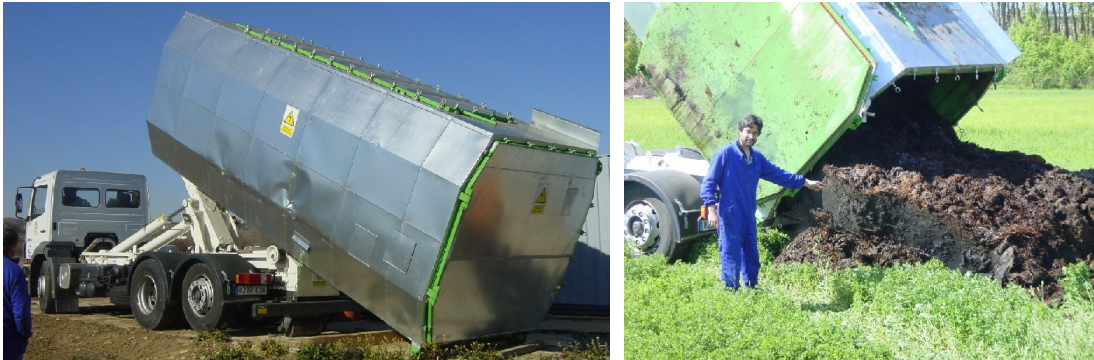
Figura A2.5. Vistas de la descarga del reactor.
