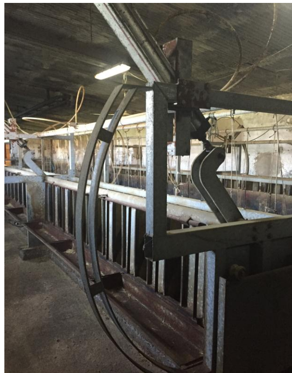
Figura 8: Estructura y comederos de la máquina de ordeño. Fuente: Elaboración propia
