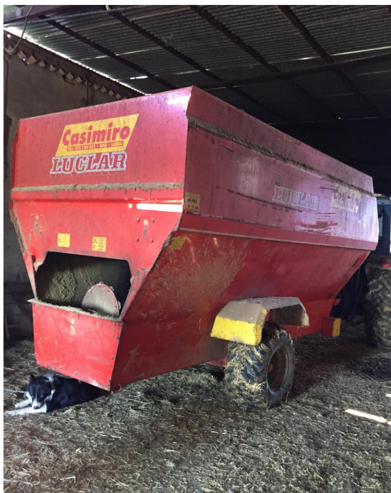
Figura 13: Carro mezclador sinfin LUCLAR utilizado en la explotación. Fuente: Elaboración propia
