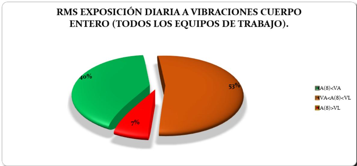
En el gráfico siguiente se representan los valores medios de exposición a vibraciones para los distintos equipos de trabajo en los que se han llevado a cabo las mediciones.
