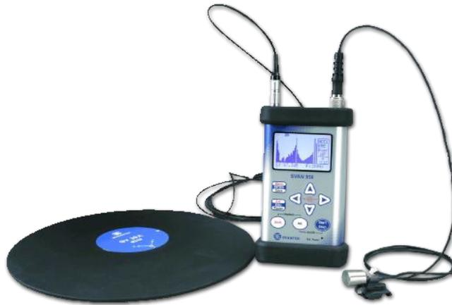
El equipo ha de configurarse correctamente antes de realizar cualquier medición en campo. Para llevar a cabo las mediciones de vibración al cuerpo entero en personas en posición sentada y con el acelerómetro sobre el asiento, se utiliza la combinación  $W_d + W_k$ , el primero de los filtros aplica al eje X y al eje Y, el segundo para el eje Z. Estos filtros se pueden definir en la configuración del equipo de medida.
