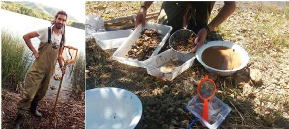
**Figura 30. Material utilizado en el trabajo de campo para el muestreo de macroinvertebrados. En la izquierda, se aprecia vadeador y red utilizada; en la derecha las bandejas y coladores.**
