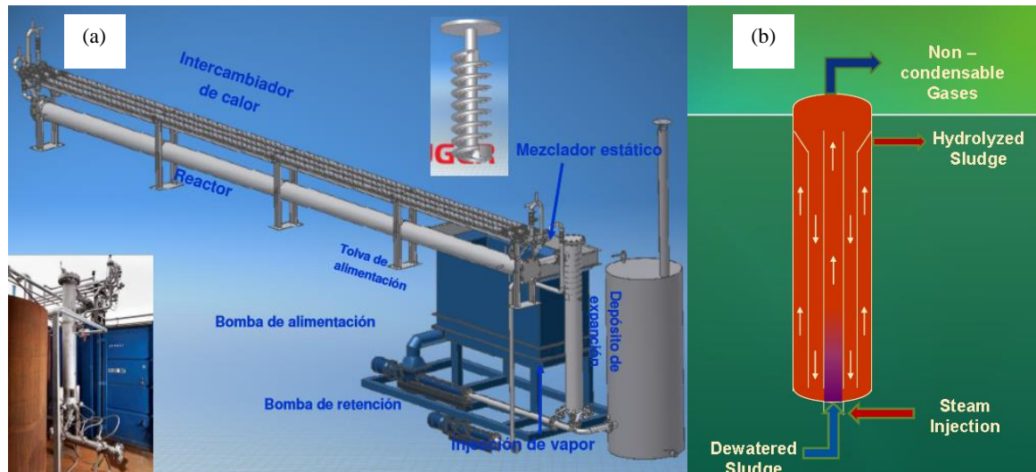
Figura 2.13. Unidad de hidrólisis térmica Exelys. a) Partes fundamentales (Veolia Water, 2011). b) Condensador-mezclador estático (Moss, 2013).
