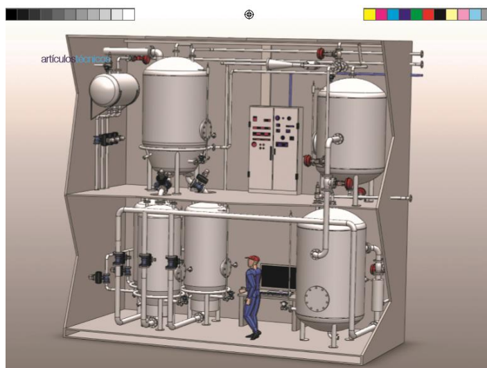
Figura 2.18. Unidad de hidrólisis térmica tH 4 + (Fernández-Polanco y González-Calvo, 2015).
