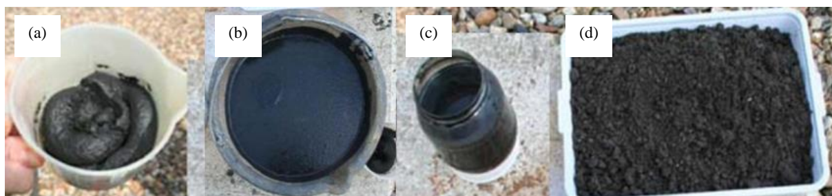
Figura 6.22. Aspecto visual de cuatro tipos de fangos. a) Fango postespesado con una concentración del 15-18%. b) Fango hidrolizado al 12-13% a la salida del flash-tank. c) Fango digerido al 6%. d) Fango deshidratado al 30-35%. (Arant et al., 2013).
