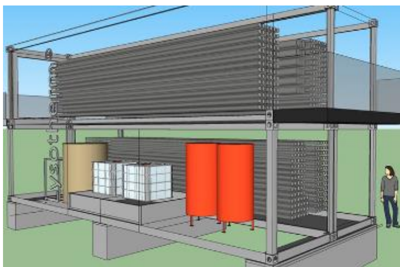
Figura 2.16. Unidad de hidrólisis térmica Lysotherm (Lysotherm, 2017).
