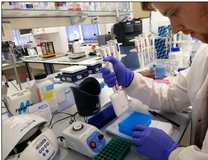
Figura 52. Proceso de dispensado con pipeta multicanal.
