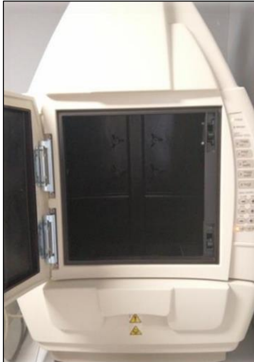
Figura 57. Aparato utilizado para la visualización y toma de imágenes de los geles (ChemiDoc).
