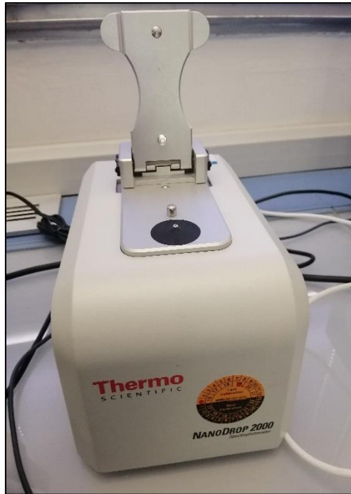
Figura 51. Espectrofotómetro UV-VIS NanoDrop2000 usado para el análisis espectrofotométrico.
