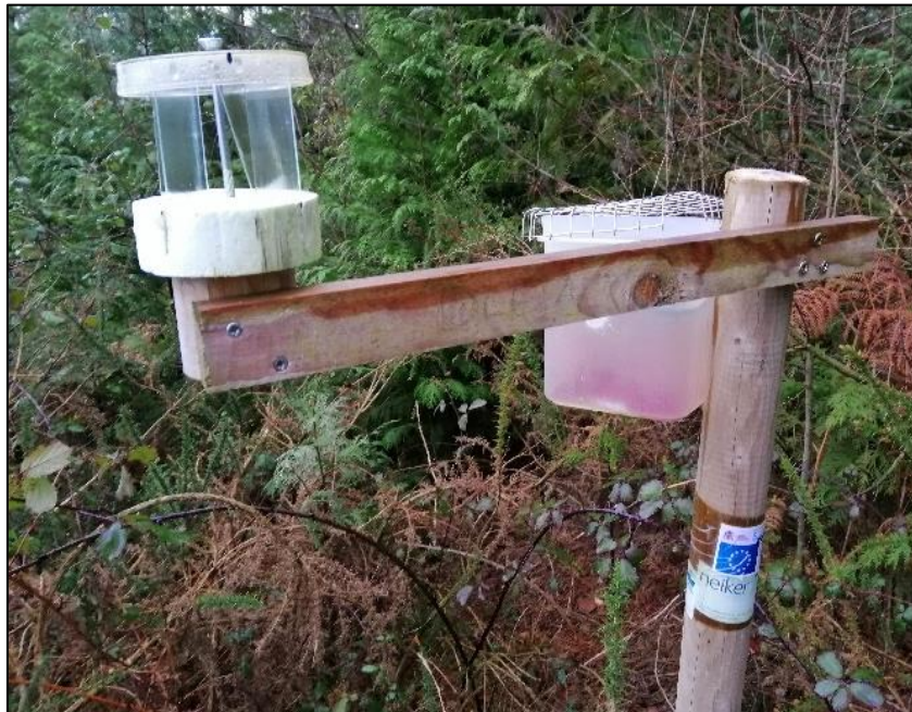
Figura 37. Trampa de esporas con placa portaobjeto junto a planta trampa de rododendro.
