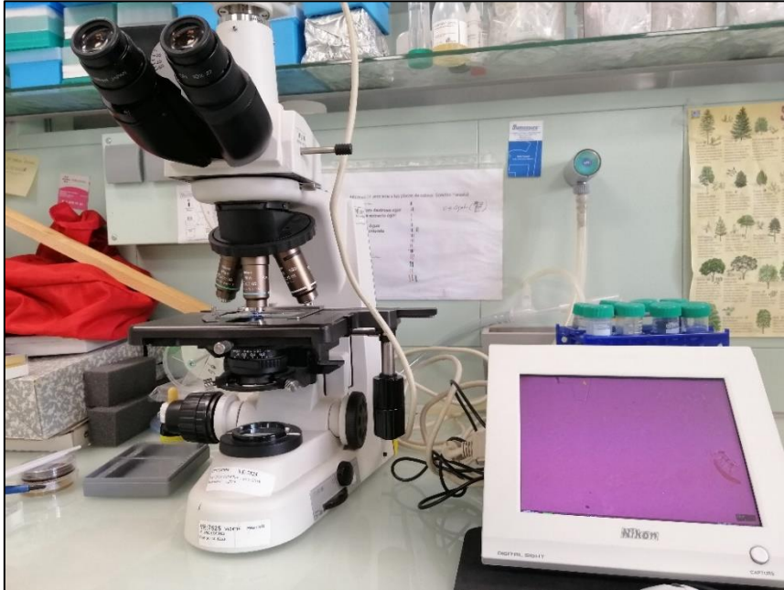
Figura 58. Microscopio de fluorescencia utilizado para visualizar las esporas.
