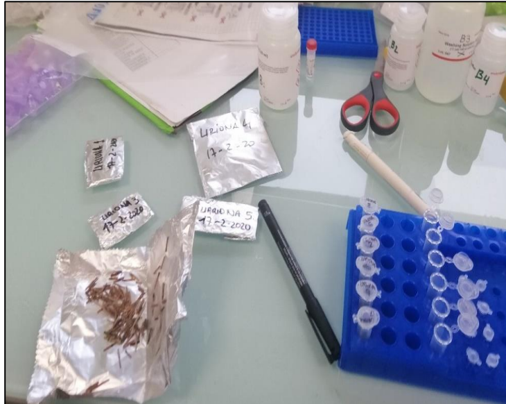
Figura 45. Porciones de acícula troceadas listas para ser introducidas en su respectivo tubo Eppendorf.
