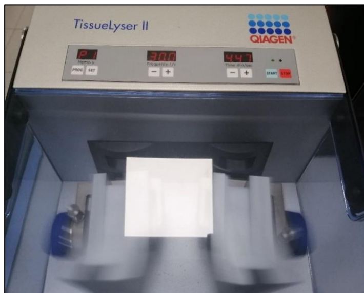
Figura 46. Proceso de ruptura de los tejidos vegetales mediante la máquina disruptora.
