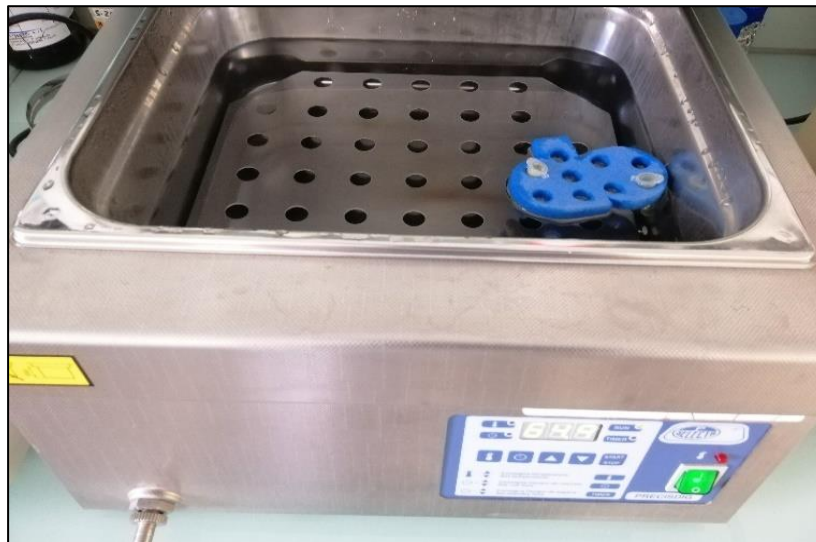
Figura 47. Baño térmico con las muestras en corcho.
