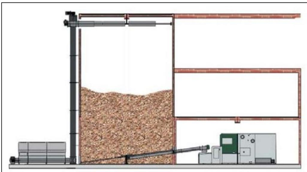
Figura 10.4. Sección vertical del silo, junto con el la caldera de biomasa de “Catalogo Grandes proyectos” (HERZ y Termosun Energías, 2019, p. 22)
