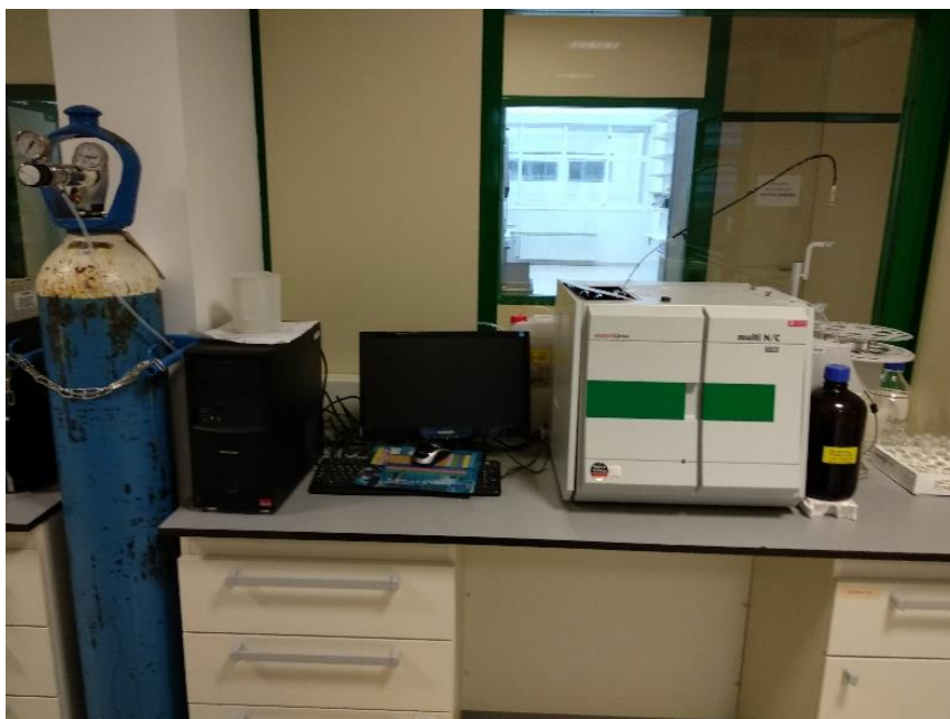
Figura 3.5 Multi N/C 3100 de AnalytikJena
