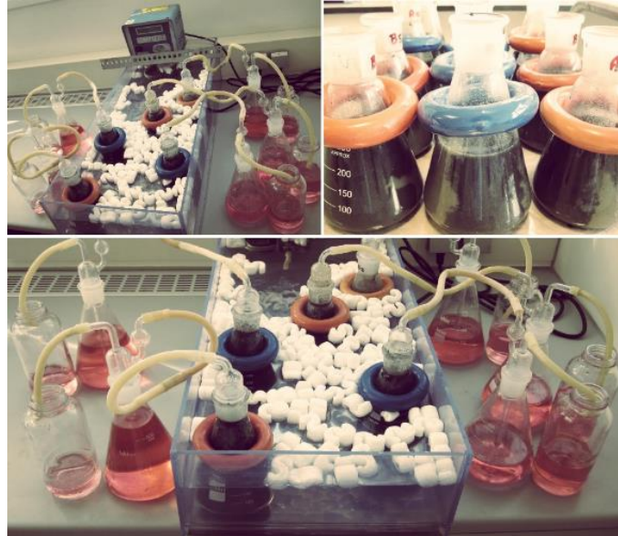
Figura 3.3 Matracas Erlenmeyer empleados para el estudio de la biodegradabilidad de los lodos de depuradora y los residuos líquidos de la industria del vino
