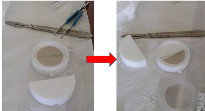
FIG. 2.12. Corte de los filtros de teflón para su posterior análisis.
