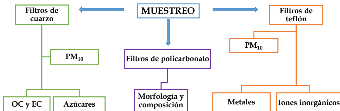
FIG. 2.11. Determinaciones químicas realizadas con los filtros de cuarzo, teflón y policarbonato recogidos durante la campaña de muestreo.
