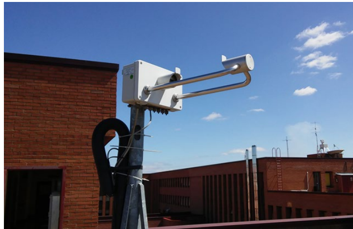
FIG. 2.10. Disdrómetro láser (LPM) de Thies Clima, ubicado en la terraza de la Facultad de Veterinaria de la Universidad de León (España).
