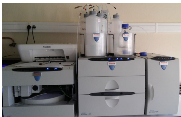
FIG. 2.15. Cromatógrafo iónico Thermo Scientific Dionex™ ICS-5000, ubicado en el Departamento de Medio Ambiente de la Universidad de Aveiro (Portugal).
