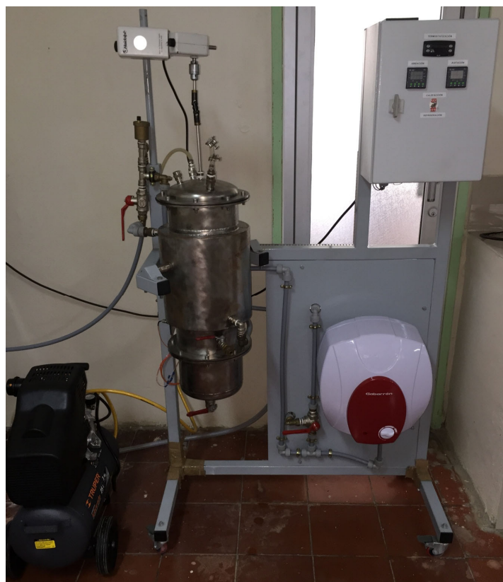
Figura 6.1. Fermentador piloto con reactor de 22,2 l de capacidad, diseñado por el grupo de investigación IQUIMAB, en el que se produjeron los inoculantes a escala piloto.
