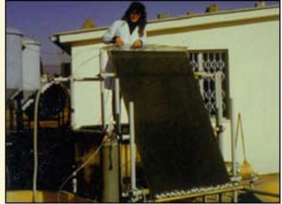
Figura 2.8. Dos tipos de fotobiorreactores cerrados exteriores. (a) Reactor tubular horizontal y (b) reactor plano inclinado.
