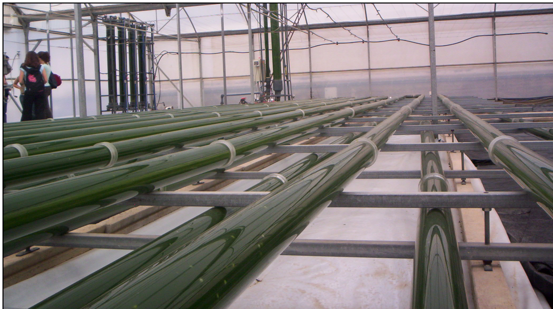
Figura 2.9. Diferentes tipos de Fotobiorreactores: (a) plano con iluminación interior utilizado para investigación, (b) plano inmerso en estanque de agua , (c) tubular horizontal impulsado por columna airlift .
