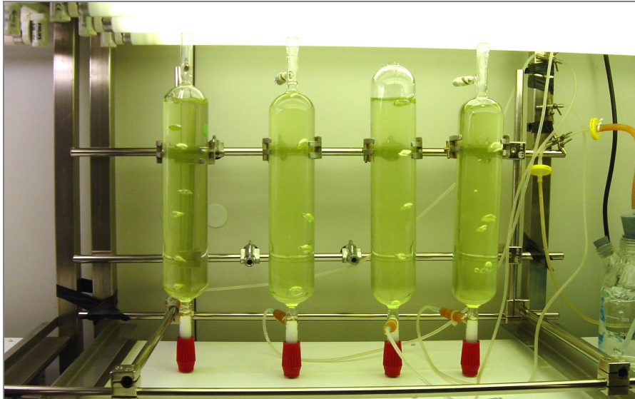
Figura 5.3. Bancada de reactores de 0,5 litros, tipo columna de burbujeo, para el cultivo de las diferentes especies estudiadas.
