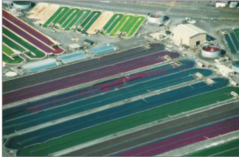
Figura 2.1. Instalación comercial de Cyanotech Corporation para la producción de microalgas, en estanques tipo race-way , en Hawaii. Los estanques de color verde son de Spirulina y los rojos, de Hematococcus pluvialis .
