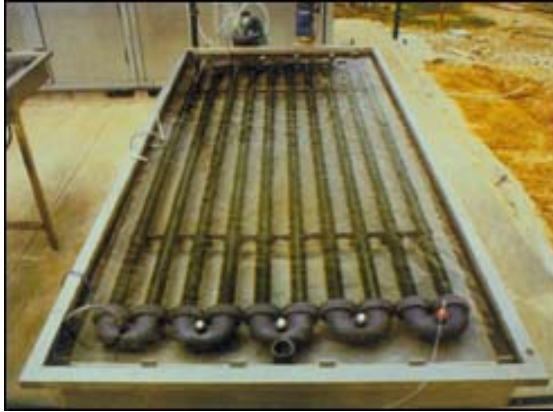
Figura 2.8. Dos tipos de fotobiorreactores cerrados exteriores. (a) Reactor tubular horizontal y (b) reactor plano inclinado.
