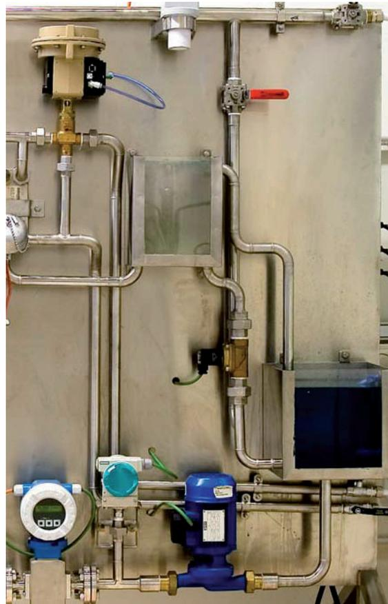
**Figura 4.14.** Circuito principal de la maqueta industrial de 4 variables.
