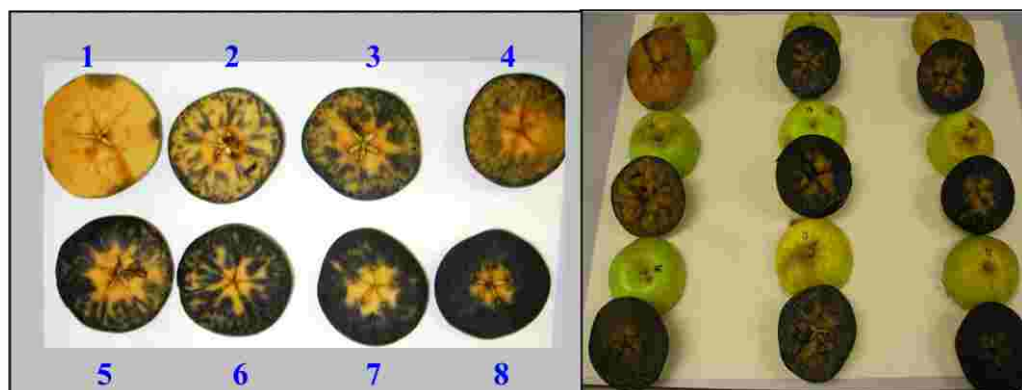
Fig. 4.21 Escala de almidón obtenida con Reineta del Bierzo. Los números se corresponden con los de la columna “Ordenación” de la Tabla 4.32.
