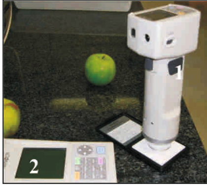
Fig.3.19. Colorímetro Minolta CR-400 formado por cabezal de medida (1) y procesador (2).
