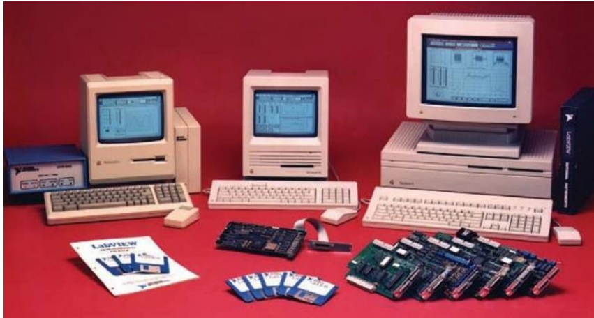
Figura 3.3 - Computadora Macintosh que ejecuta el entorno de programación LabView de National Instrument y tarjetas de adquisición de datos (Fuente: [4])
