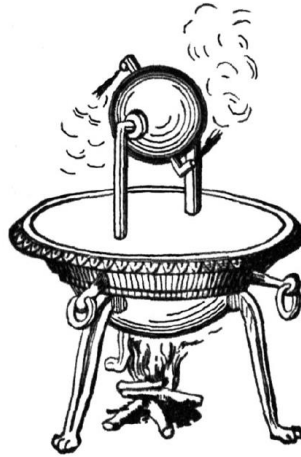
Figura 1.4: Máquina de Herón, o aelolipile [8]
