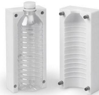
*Ilustración 3 Fase de los moldes: molde de soplado de PET de policarbonato (5).*
