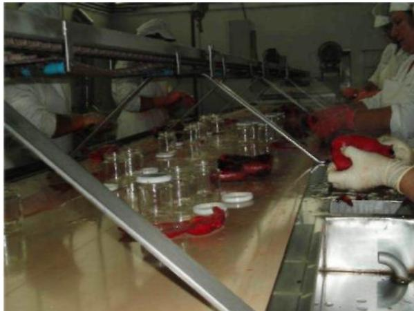
Figura 3.12. Proceso de pelado a mano en la industria
