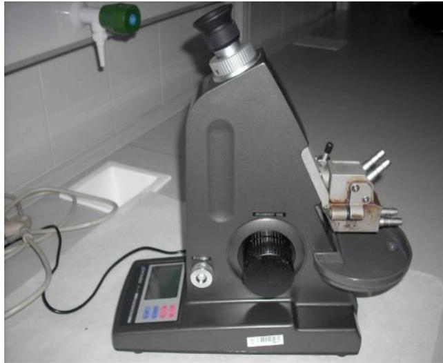
Figura 3.3. Refractómetro de mesa (Fuente propia, 2009)
