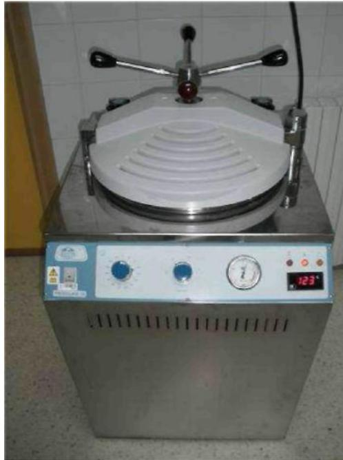
Figura 3.9. Autoclave eléctrico (Fuente propia, 2009)
