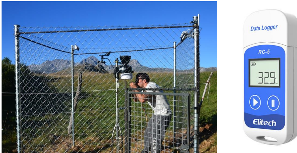
Fig. 7. Instalación de la estación meteorológica Davis Vantage Pro con sistema Holfuy en la dolina de Prado Veneiro, el 28 de julio de 2019. A la derecha, datalogger Elitech RC-5 utilizado como apoyo para una posible pérdida de datos
