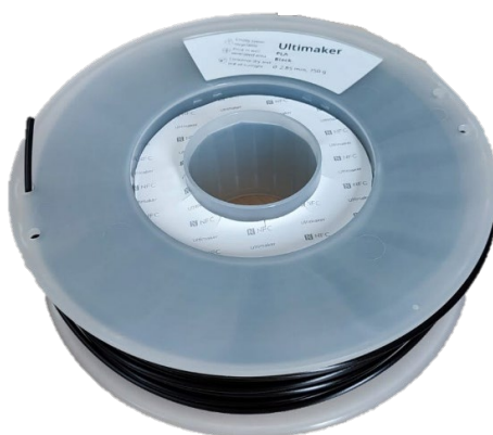
Figura 3.14. Material utilizado: filamento PLA negro Ultimaker de diámetro 2,85 mm y peso 750 g. Fuente: elaboración propia.
