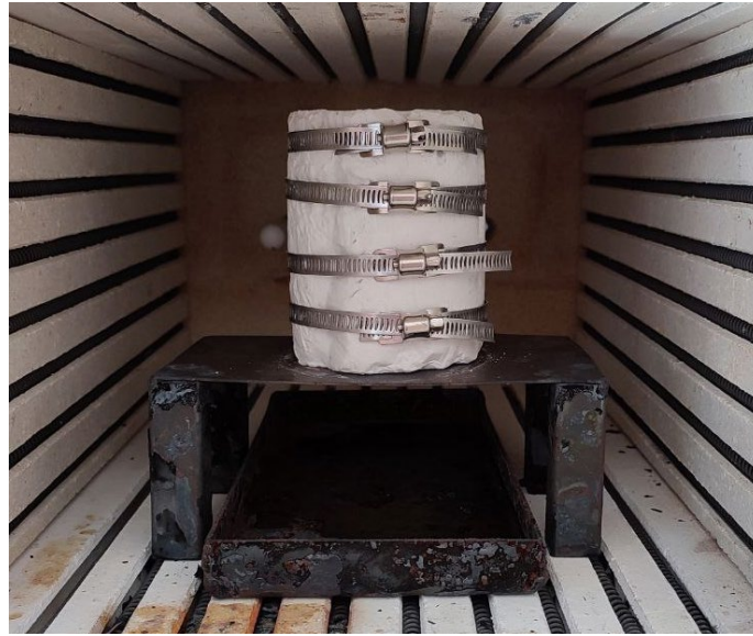
Figura 3.21. Pieza de revestimiento en el horno, utilizando abrazaderas como estructura para evitar ruptura térmica durante el tratamiento térmico sobre el soporte individual y bandeja. Fuente: Elaboración propia.
