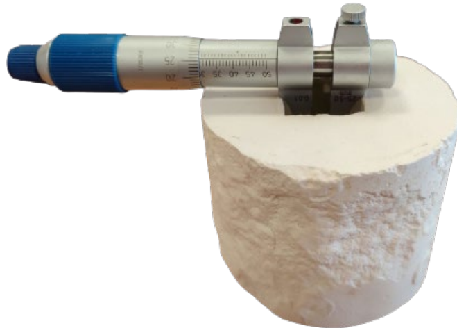
Figura 3.30. Micrómetro de interiores. Equipo del grupo de investigación TAFi de la ULE. Fuente: Elaboración propia.
