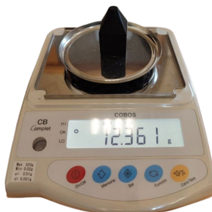
Figura 3.26. Balanza de precisión COBOS. Equipo del grupo de investigación TAFI. Fuente: Elaboración propia.
