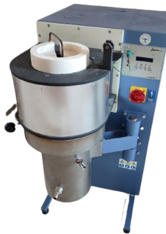
Figura 3.37. Fundidora de Inducción Agatronic R . Equipo del grupo de investigación TAFI de la ULE. Fuente: Elaboración propia.
