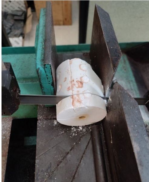
Figura 3.23. Detalle de prueba de corte de un molde de revestimiento. Fuente: Elaboración propia.
