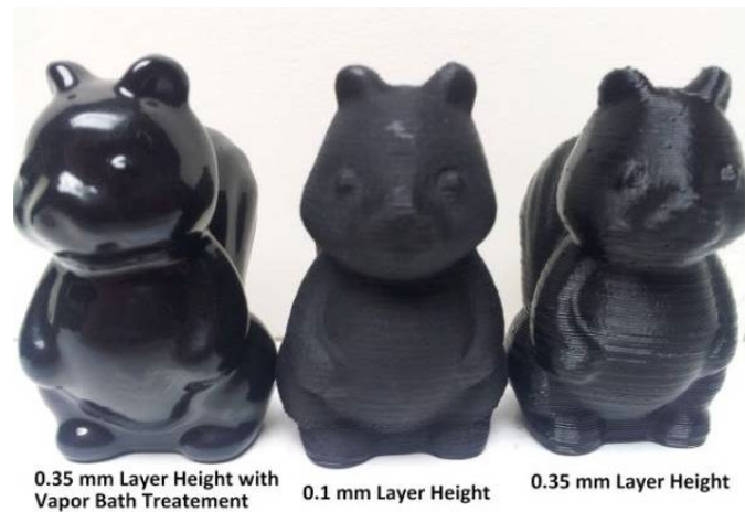
Figura 3.3. Comparación entre la misma pieza fabricada con una altura de capa de 0,35 mm con postproceso en baño de vapor, fabricada con una altura de capa de 0,1mm sin postproceso e fabricada con una altura de capa de 0,35 mm sin postproceso. Fuente: [21].
