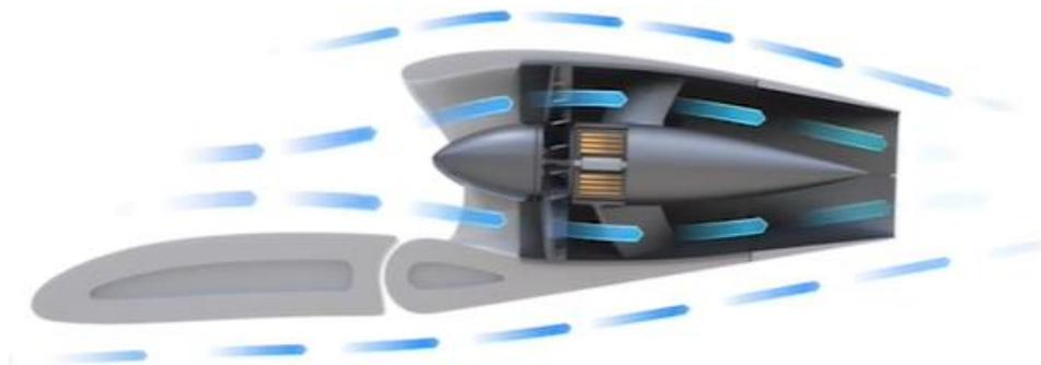
Figura 1.10. Recorrido del flujo de aire en torno al ala y los motores [17].
