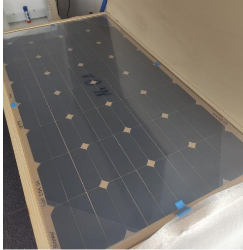
Figura 33. Panel de Gochermann Solar. Sin diodos de Bypass.
